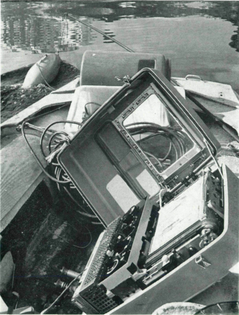
Abb. 1: Echograph ELAC-Castor LAZ 17 CT 3 W-T mit „Fisch“ während des Lotens.
