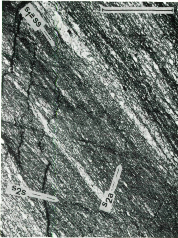
Abb. 3: Phyllitischer Tonschiefer der Magdalensbergserie am Griffener Berg. Dünnschliff, ohne Nicols, Maßstab = 1 mm. ss = Schichtung; s_1 = 1. Schieferung; s_{2s} = synthetische 2. Schieferung; s_{2a} = antithetische 2. Schieferung. (Die Indizierung für syn- bzw. antithetisch gilt nur unter der Voraussetzung, daß die Gesamtrotation nach links/Norden erfolgt ist.)
