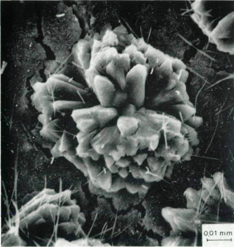
Abb. 6: Rosettenförmige Kalzitneubildungen aus amorpher Grundmasse.
