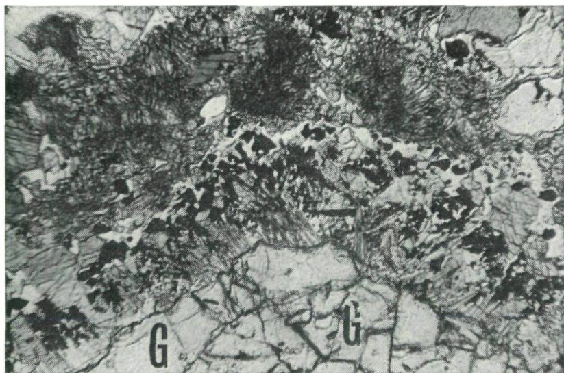
Abb. 2: Eklogitamphibolit mit Hornblendekelyphit. — Geschiebe aus der Drau bei Schloß Hollenburg. — Vergr. = 150 x. Ein Pol., Durchlicht. Teil eines Granatporphyroblasten (G), an dessen deutlich korrodiertem Rand die ungleich dicke Hornblendekelyphit-Rinde ansetzt. Diese besteht aus im großen und ganzen radial gestellten Hornblendenadeln, nach außen hin anschließend Hornblendeprismen und in zunehmender Zahl bzw. Größe auch „Ilmenit“-Körner, welche sich alle in einem Quarz-„Grund“ (am Außenrand der Kelyphitrinde besonders deutlich) befinden. Diese Kelyphitrinde ist somit wesentlich anders gebaut als die im erstbeschriebenen Eklogitamphibolit. Nach außen (bzw. nach oben) schließt sich das Grundgewebe an, in dem Hornblendediablasten vorherrschen. Rechts oben auch ein Quarz- (unteres Korn = 0,1 mm) und Epidotkorn (beide im Bild weiß).
