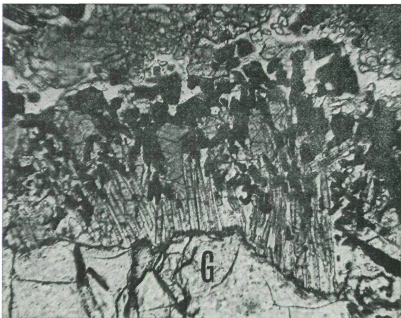
Abb. 3: Eklogitamphibolit mit Hornblendekelyphit. — Geschiebe aus der Drau bei Schloß Hollenburg. — Vergr. = 450 x. Ein Pol., Durchlicht. Vergrößerter Ausschnitt aus Abb. 2, um den Einblick in den Bau der Kelyphitrinde um den Granatporphyroblasten (G) noch anschaulicher zu gestalten.
