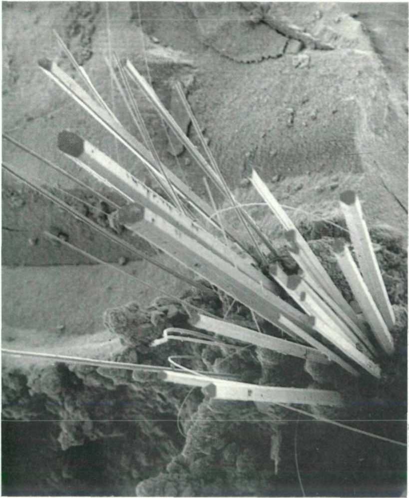
Abb. 4: Einige Erionitnadeln mit zahlreichen stark gekrümmten Erionitfäden. Vergrößerung etwa 230 x.
