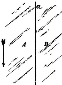
Ein an der Rutschfläche liegendes Theilchen *a* wird dann ebenfalls nach abwärts zum Ausschlag gebracht werden und in einer verticalen auf der Rutschfläche lothenden Ebene vibriren. In gleicher Weise wird das Schwingen irgend eines anderen von der Rutschfläche entfernteren Theilchens erfolgen, das von *a* aus angeregt wurde.
