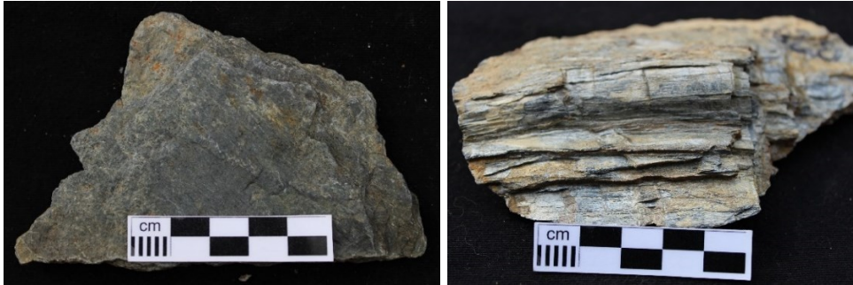
Abbildung 11: Handstücke des phyllitischen Ton- bis Siltschiefers . Die engständige Schieferung (wenige mm) ist zu erkennen. Zudem liegt ein seidiger Glanz durch den Hellglimmer vor (rechts).
