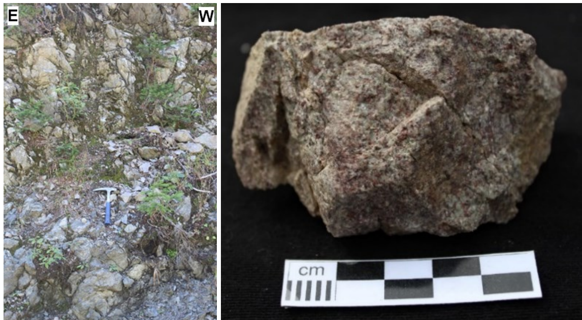
Abbildung 22: Einziger Aufschluss im Kartiergebiet (links) und Handstück des rötlichen Sandsteins (rechts). Der Aufschluss ist stark kataklastisch und mit kleinen Bäumen und Sträuchern bewachsen. Er befindet sich etwa 400 m westlich vom Gipfel des Schwenderecks. Das Gefüge des rötlichen Sandsteins erscheint makroskopisch texturell isotrop. Der rötliche Sandstein weist eine rötliche bis rotgraue Farbe auf. Aufschlussnummer: 09081450.
