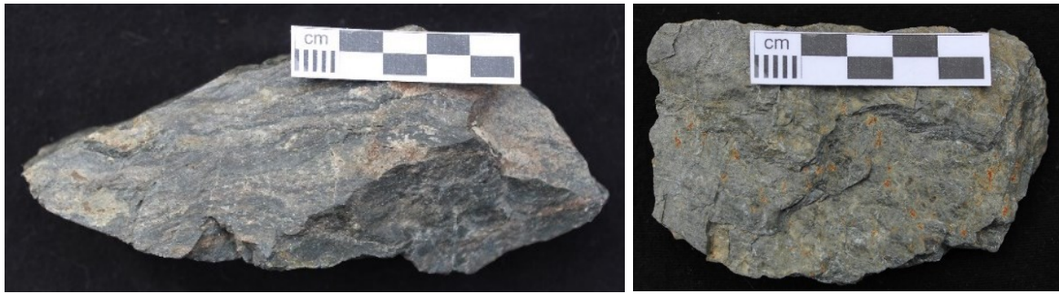
Abbildung 29: Handstücke des kataklastischen Gesteins unbekannter Lithologie . Eine kompositionelle Bänderung (links) und eine grünliche Verwitterungsfarbe (rechts) ist zu erkennen.
