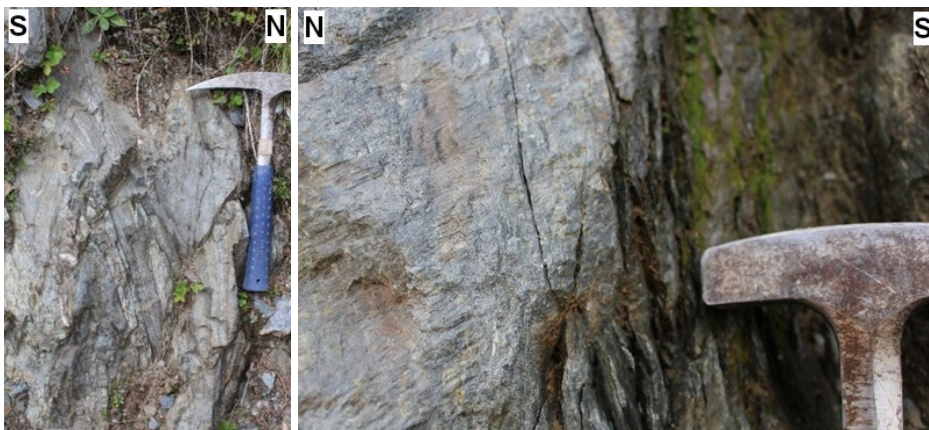
Abbildung 16: Kleinräumige Faltung (links) und Störungsflächen mit Harnischstriemungen (rechts) im Ton- bis Siltschiefer . Aufschlussnummern: 12081200 (links) und 15081450 (rechts).
