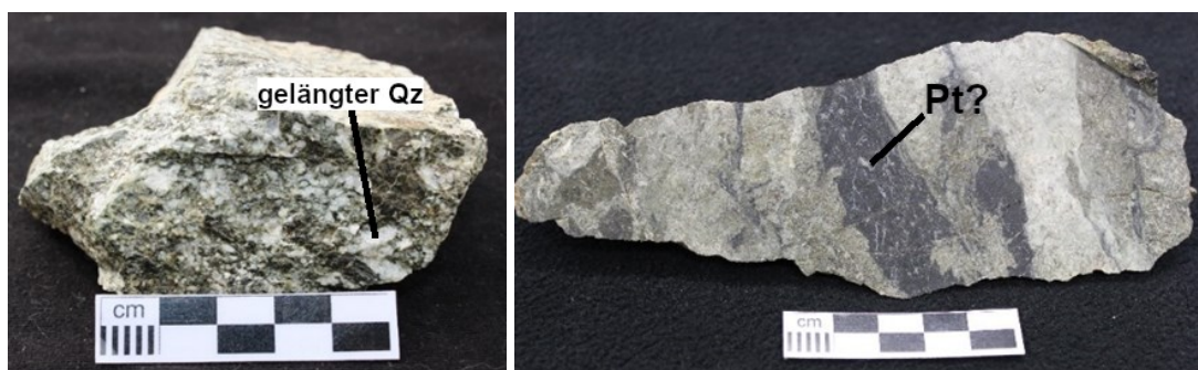
Abbildung 24: Handstücke des Tonalits . Eine Foliation im Tonalit ist durch gelängte Quarz-Klasten (Qz) erkennbar (links). Eine geschnittene Fläche zeigt ein schwarzes Störungsgestein (Pt?; rechts). Das Handstück entspricht der Probe 20081230-1.
