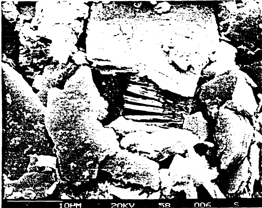
Abb. 4/6: Probe BL 5/86-30,35 m. "Geldröllchen" von Kaolinit im Glimmer/ Feldspat/Quarz-Sand. REM, Balkenmaßstab: 10 Mikron.
