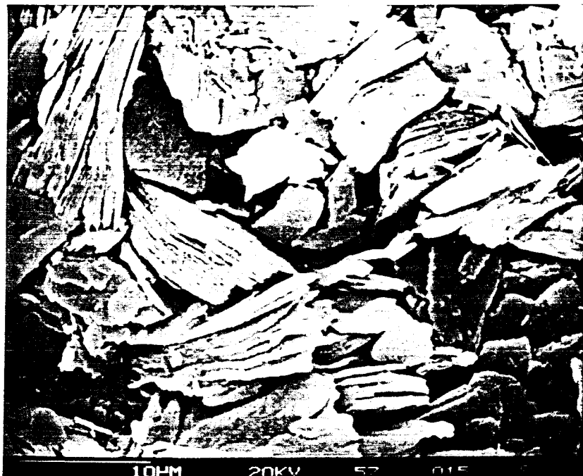
Abb. 4/5: Probe BL 5/86-21,75 m. Mehr oder weniger korrodierte chaotisch angeordnete "Geldröllchen" von pseudohexagonalem Kaolinit. Die Probe stammt aus einem Kluftbesteg in einem Kaolinit/Quarz-Sand-Gemisch. REM, Balkenmaßstab: 10 Mikron.
