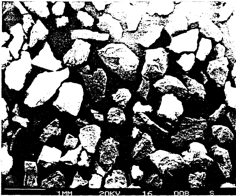
Abb. 4/9: Probe 10/88. Grobsand angular, schlecht sortiert, Kornfraktion bis 1 mm. REM, Balkenmaßstab 1 mm.
