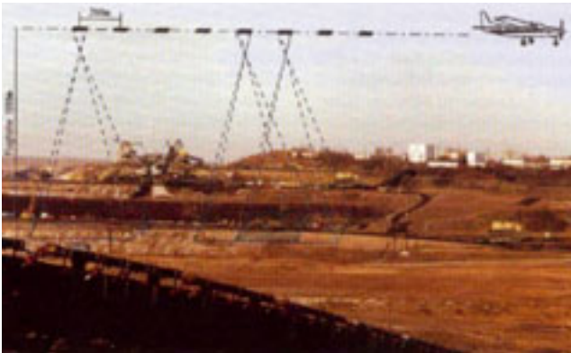
Abb. 7-3-12: Bildflugkonfiguration für eine monatliche Tagebaubefliegung (aus REETZ 1997)
