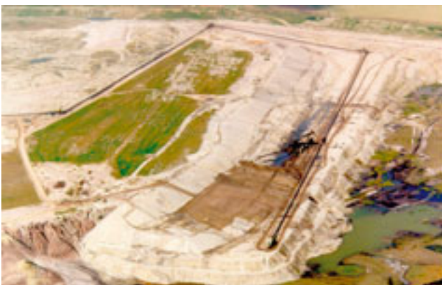
Abb. 5-2-52 : Stützdammerschüttung Innenkippe Peres
