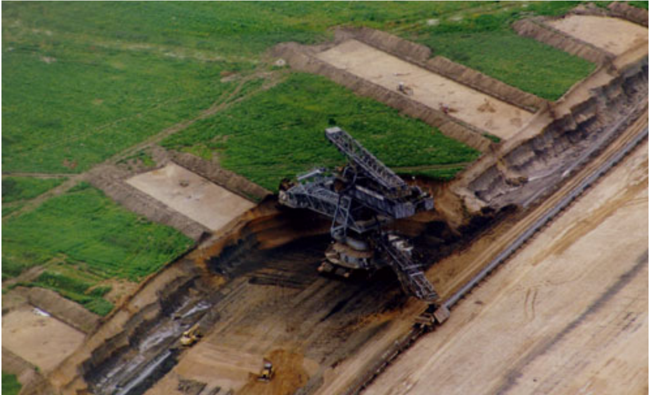
Abb. 5-2-22: Bagger 1522 SRs 1200 von TAKRAF Lauchhammer im 1. Abraumschnitt des Tagebaus Zwenkau (1998) (Foto: Archiv LMBV mbH)
