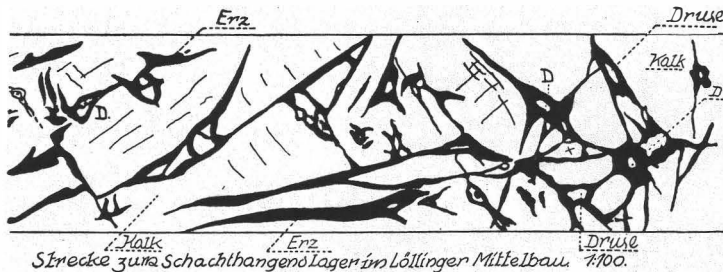
Abb. 17. Sideritgänge mit reicher Drusenbildung im Kalk. Strecke zum Schachthangendlager im Löllinger Mittelbau. 1 : 100.
