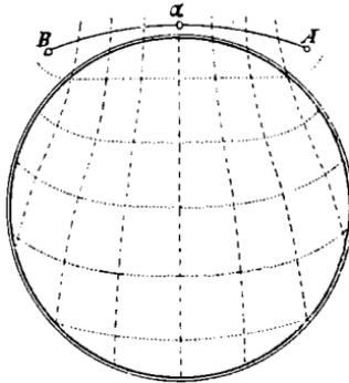
Skiodromen eines optisch zweiachsigen negativen Krystalls im Schnitt senkrecht auf der Ebene  $\alpha\beta$ ,  $45^\circ$  mit  $\alpha$  und  $\beta$  einschließend.
