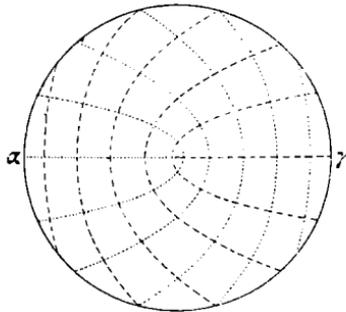
Skiodromen eines neutralen optisch zweiachsigen Krystalls ( $2V = 90^\circ$ ) im Schnitt senkrecht zur optischen Achse. In Diagonalstellung ist die Isogyre ein gerade gestreckter Balken.
