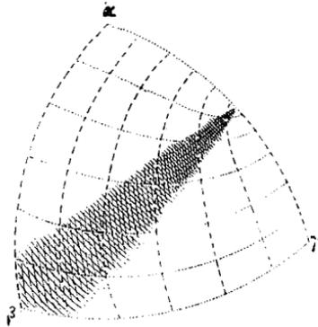
Skiodromen eines optisch zweiachsigen neutralen Krystalls ( $2V=90^\circ$ ). Schiefer Schnitt zwischen Achse und Normale. Die zentrale Isogyre verläuft geradlinig und diagonal.
