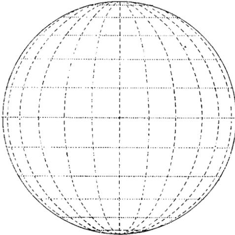
Skiodromen eines einachsigen negativen Krystalls. Schnitt parallel zur Achse.
