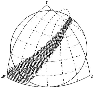
Skiodromen eines optisch zweiachsigen negativen Krystalls ( $2V=60^\circ$ ). Schiefer Schnitt zwischen Achse und Normale. Zentrale Isogyre krumm, schließt mit den  $\alpha$ -Skiodromen den kleineren Winkel ein.
