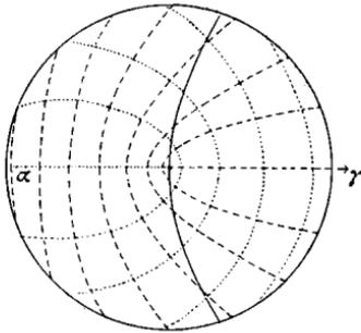
Skiodromen eines optisch zweiachsigen negativen Krystalls, Schnitt senkrecht zu einer der optischen Achsen. Nur der Mittelteil der Konstruktionskugel ist gezeichnet, der das Gesichtsfeld des Konoskops erfüllt. Man beachte, daß die Isogyre in Diagonalstellung ihre konvexe Seite der ersten Mittellinie zukehrt. Die Meridian-Skiodromen innerhalb der Höhlung der Hyperbel entsprechen der Schwingungsrichtung der rascheren Welle  $\alpha'$ .
