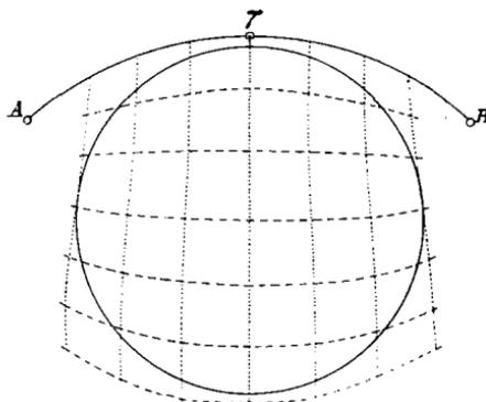
Skiodromen eines optisch zweiachsigen negativen Krystalls im Schnitt senkrecht auf der Ebene  $\gamma\beta$ ,  $45^\circ$  mit  $\gamma$  und  $\beta$  einschließend.
