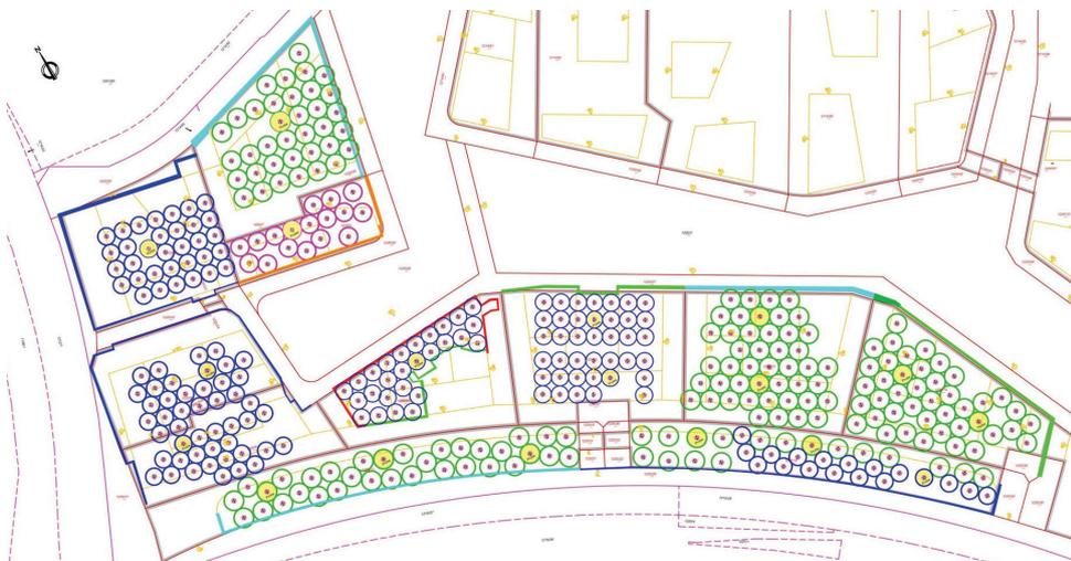
Abbildung 3: Sondenausteilung Bauvorhaben Village im Dritten, Bauphase 1 (400 EWS).
