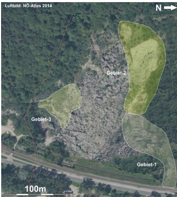
Abbildung 2: Strukturgeologische Homogenbereiche im Bereich Tagbau Spitz (Luftbildaufnahme aus dem Jahr 2014; Quelle: atlas.no.e.gv.at).
