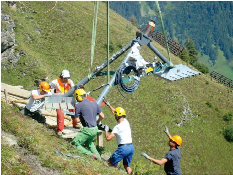
Abbildung 8: Dreibein-Prüfeinrichtung für Abnahmeprüfungen (WLV Imst).
