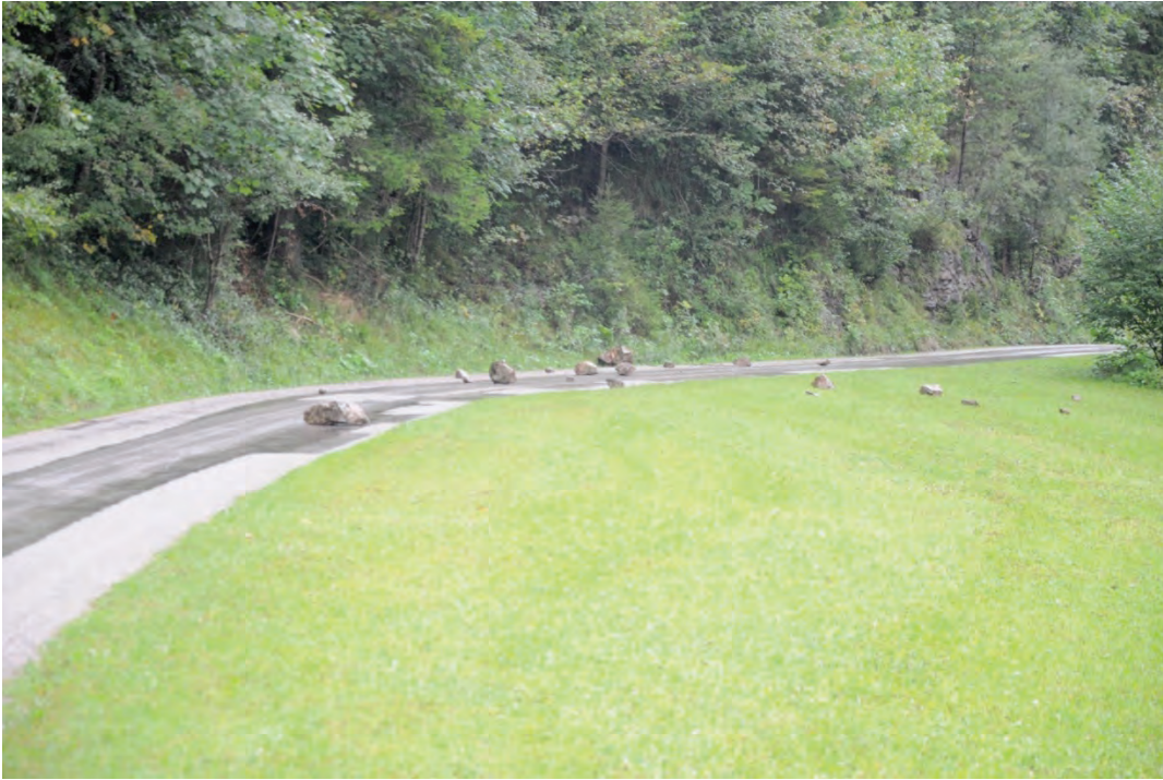
Abbildung 11: Sturzversuche in Schwarzenbach an der Pielach – Endlagen der Sturzblöcke, die unterhalb des bewaldeten Hangabschnitts zum Stillstand gekommen sind (Photo: A. Preh).
