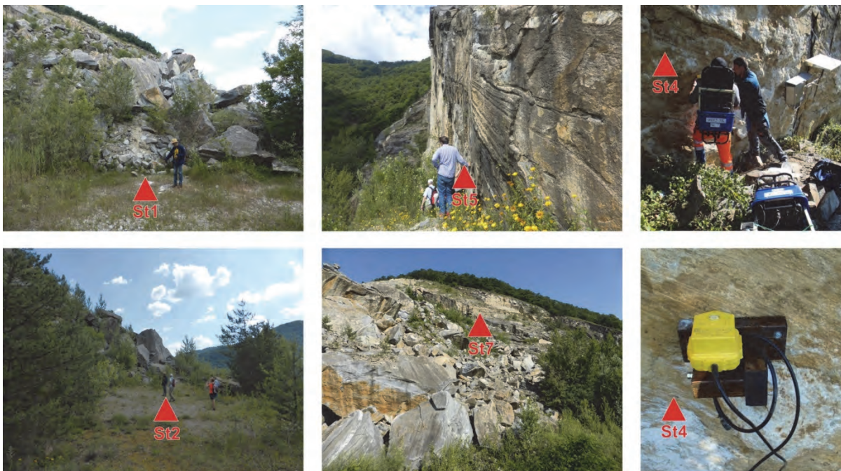
Abb.4. Auswahl der seismischen Stationen 1, 2, 5 und 7; Geophon-Montage und horizontierbare Halterung des Geophons bei Station 4.
