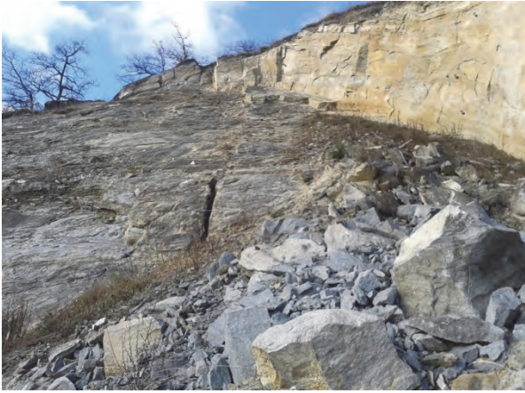
Metallspione an großer offener Kluft
