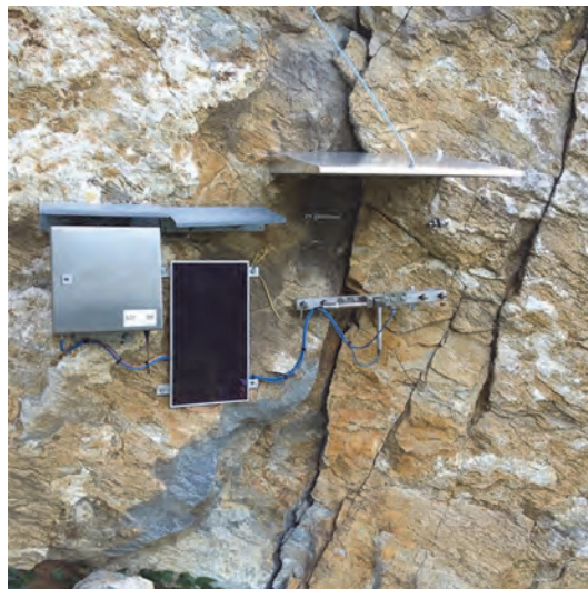
3-D Fissurometer mit Funkübertragung
