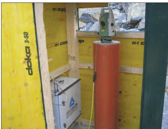
Hütte mit vollautomatischen Tachymeter
