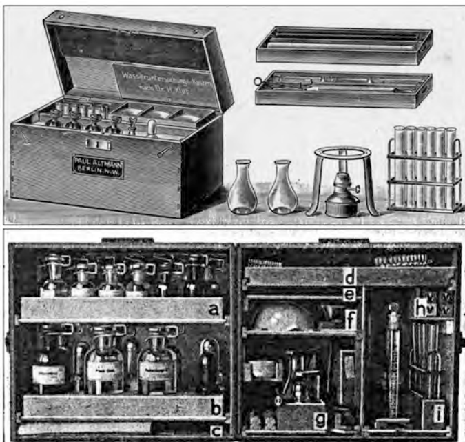
Abb. 10: Wasseruntersuchungskasten nach Klut (1931; oben) und „Wasseruntersuchungsgerät für wehrgeologische Zwecke“ (1942, unten; Oberkommando des Heeres, 1942; Bestand RH 8/861, Reproduktion mit Genehmigung Bundesarchiv).
