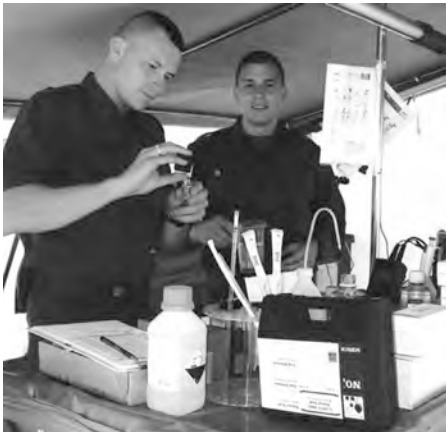
Abb. 23: Schnelltestchemikalien erlauben eine rasche Qualitätsprüfung von Wasserproben (Bock, 2015; Foto Österreichisches Bundesheer).
