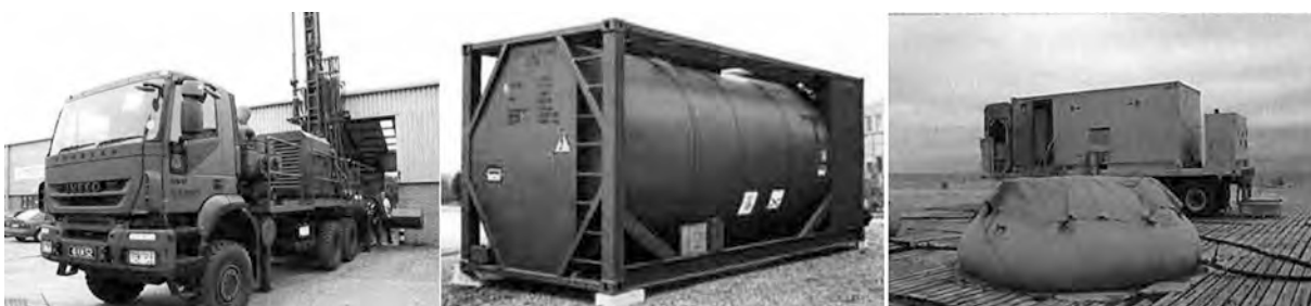
Abb. 17: Für internationale Einsätze konzipiertes mobiles Bohrgerät (links) und Beispiele für einen robusten Wassertransportbehälter (Mitte) und ein mobiles Wasserlagersystem (rechts; nach Lampl, 2013; Reproduktion mit Genehmigung der Redaktion ABC-Abweherschule, Korneuburg).
