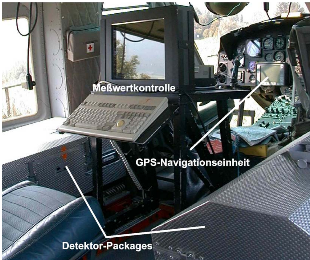
Abb. 2: Arbeitsplatz im Helikopter. Die 2 Detektor-Packages beinhalten ein Detektorvolumen von insgesamt ca. 34 l. Die Messwertkontrolleinheit dient zur Steuerung der Messung und zur laufenden Kontrolle der Messergebnisse. Die GPS-Navigationseinheit zeigt dem Co-Piloten die Position und die Abweichung vom vorgegebenen Flugweg.
