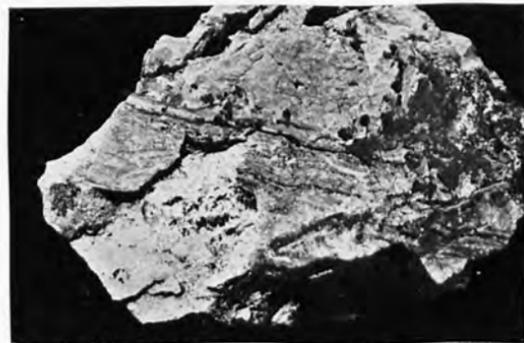
Fig. 3. Vordringen des Bleiglanzes (blau) von Spalten aus. Handstück von Galmeierzzug zwischen II. und III. Firstenlauf (Helena-Grube, Mieß, Kärnten). (2/8 der nat. Größe.)
