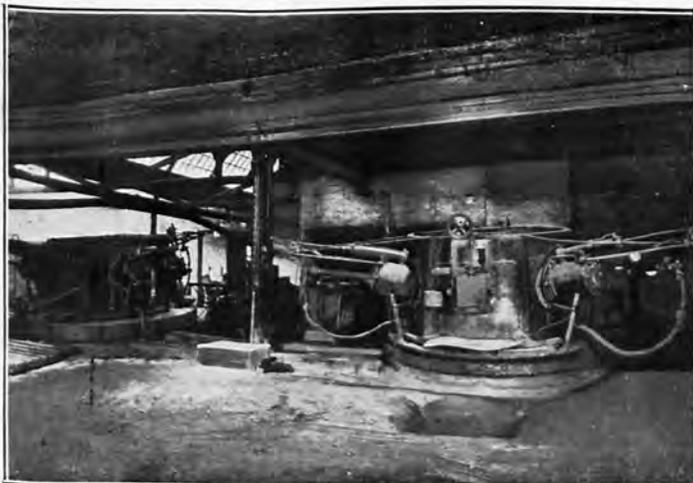
Fig. 26. Zwei drehbare Stassano-Öfen für je 1000 kg Einsatzgewicht (Rheinische Elektrostahlwerke, Bonn a. Rh.).
