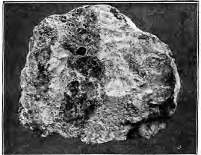
Fig. 1. Magnesit (licht) mit eingeschlossene Resten von Serpentin (dunkel).
