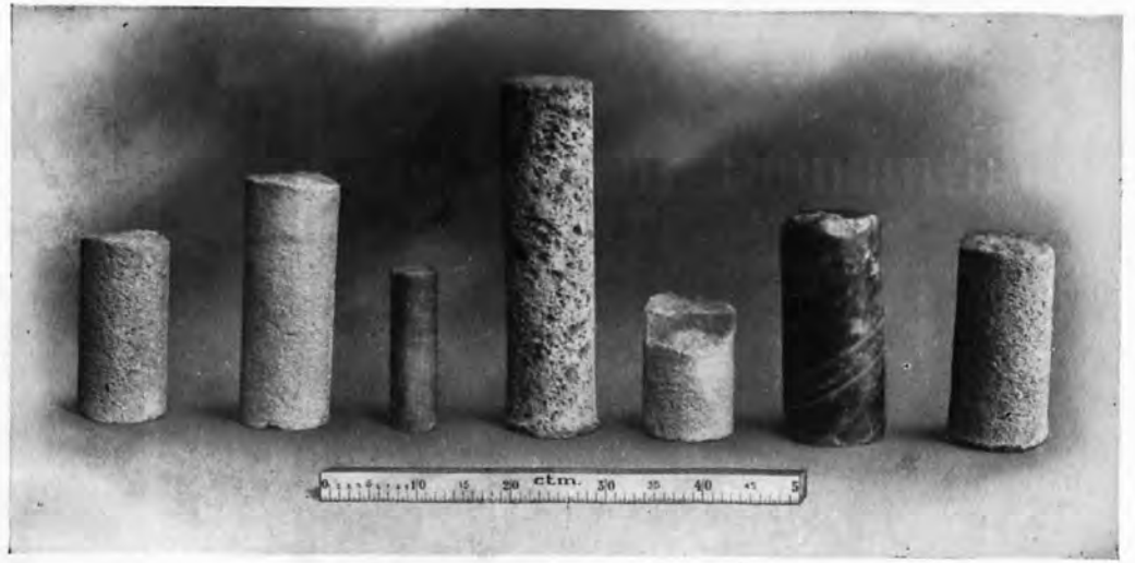
Fig. 3. Stoßbohrkerne größeren Durchmessers mit separaten Kernfangapparaten gefördert.
