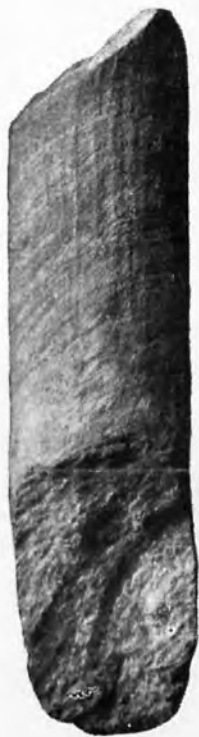
Fig. 1. Hydraulisch gehobene Stoßbohrkerne (Naturgröße).
