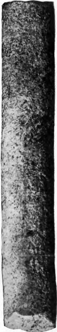
Fig. 1. Hydraulisch gehobene Stoßbohrkerne (Naturgröße).
