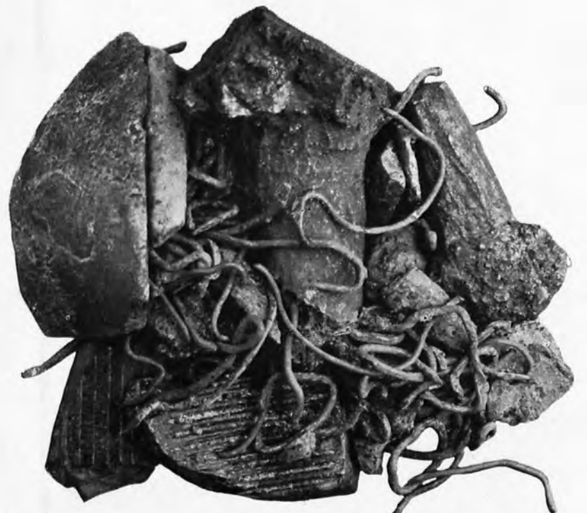
Fig. 6. Mit umgekehrter Spülung gehobene, zum Teil angebohrte Eisenstücke (Naturgröße).
