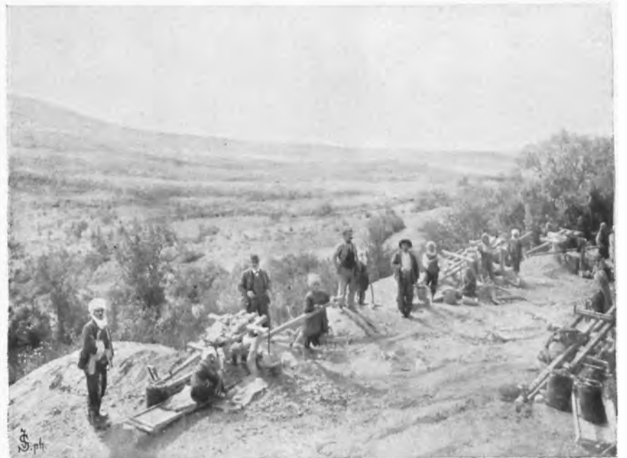
Fig. 8. „Laverie Sarde“ (Siebsetzen) im Blei-Zinkbergbau Oued-Boudouka (Algerien).
