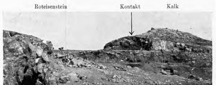
Fig. 21. Die oberste Etage des „Zrissa“. Rechts Kontakt von Kalk (licht) und Roteisenstein (dunkler).
