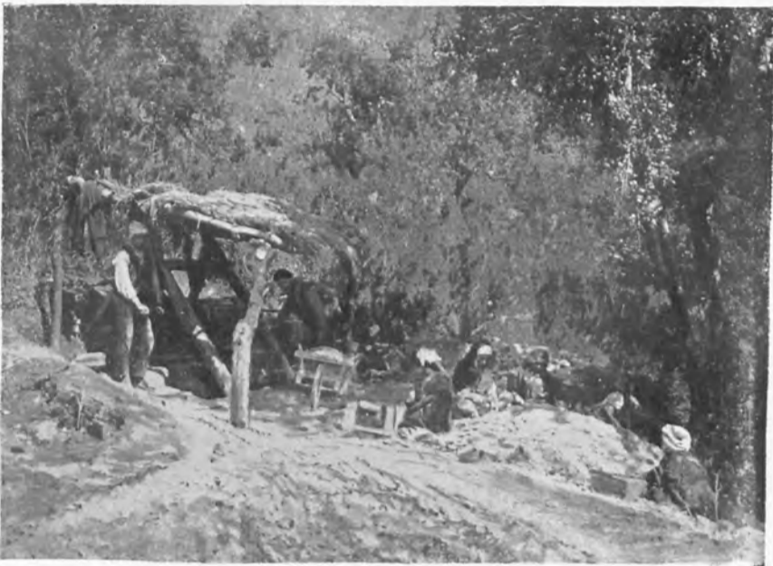
Fig. 7. Schurfschacht und Aufschlägeln des Hauwerks; Blei-Zinkbergbau Oued-Boudouka (Algerien).
