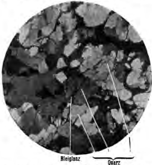
Fig. III m. Ein Bleiglangang durchsetzt drei verschiedene Quarzindividuen. Nic. †.
