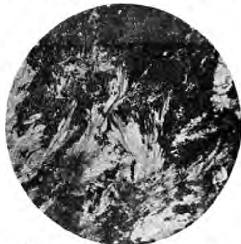
Fig. IV 1 m. Ebenlagenförmige (links) und konzentrisch lagenförmige Struktur. Fig. V m. Verwachsung von Tremolit (licht) mit Zinkblende (dunkel). Nic. parallel.
