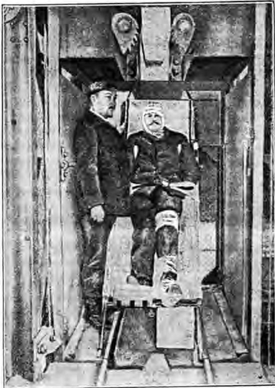
Ein weiterer Umstand muss noch erwähnt werden, u. zw. der, dass die Tragbahre zugleich den bestehenden Rettungswagen angepasst werden kann, so dass die nötige Hilfeleistung, wie Blutstillung und Notverbände, obertags auf dieser Tragbahre gemacht werden können, ohne den Verletzten, wie bis jetzt, von der Grubentragbahre auf die Bahre des Rettungswagens umlagern zu müssen. Der Verletzte kann auf meiner Tragbahre nach erhaltener Hilfeleistung in den Rettungswagen hineingeschaft werden.
