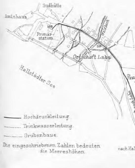
Fig. 1. Situation der Druckwasserleitungen der k.k. Saline Hallstadt.
