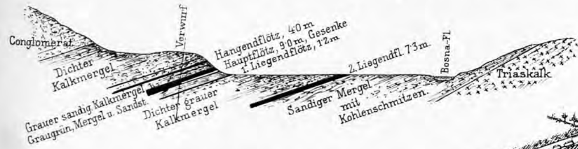
Fig. 3. Längsschnitt durch das Gesenke in Zenica. 1:1250.
