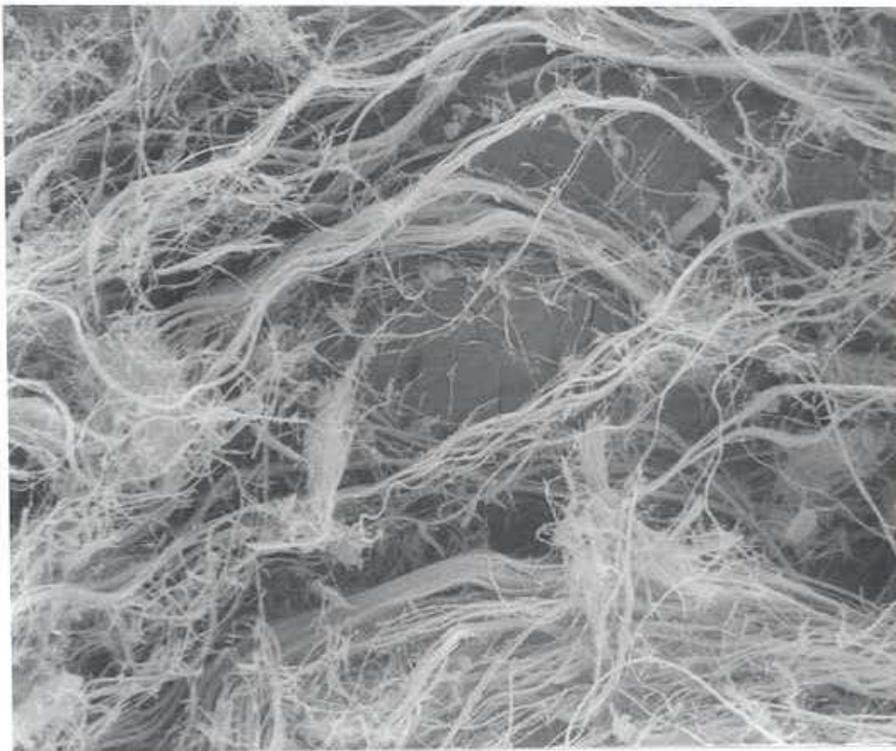
Abb. 45: REM-Aufnahme von Chrysotilasbest. Vergrößerung: 750fach.
