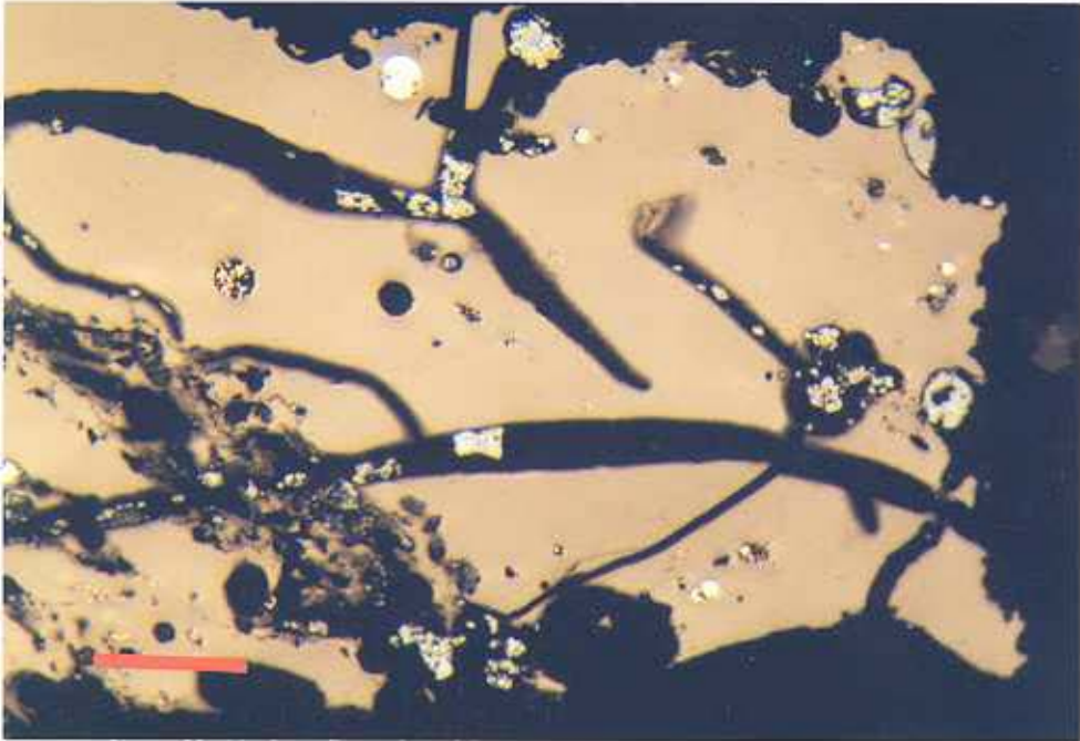
Abb. 7: polierter Anschliff einer Kohlekraftwerks-Asche (magnetische Fraktion). Unregelmäßiges, kohliges Material mit Einschlüssen von Magnetkies (weiß, z. T. globular). Ölimmersion Marke = 0.05 mm
