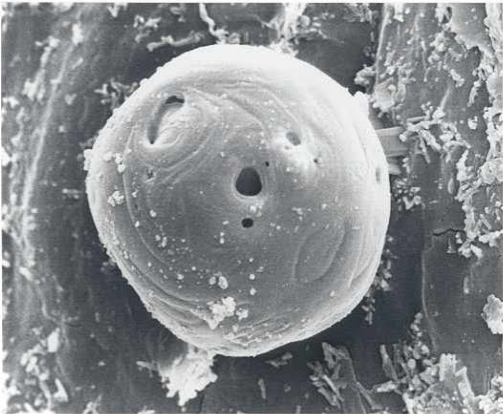
Abb. 8: REM-Aufnahme eines hohlkugeligen Partikels. Vergrößerung: 4500 fach.
