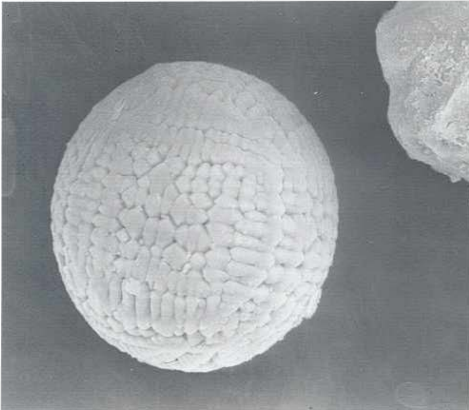
Abb. 31: REM-Aufnahme eines dendritischen Spinellkorns (mögliche Herkunft: LD-Schlacke als Zuschlagstoff) nahe Zementwerk. Vergrößerung: 2800fach.
