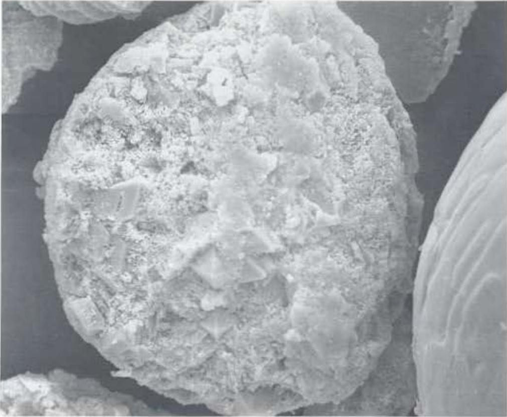
Abb. 18: REM-Aufnahme eines globularen (Fe, Mn)-Mischoxidkorns aus einer Staubprobe nahe Eisen- und Stahlindustrie. Vergrößerung: 2000fach.
