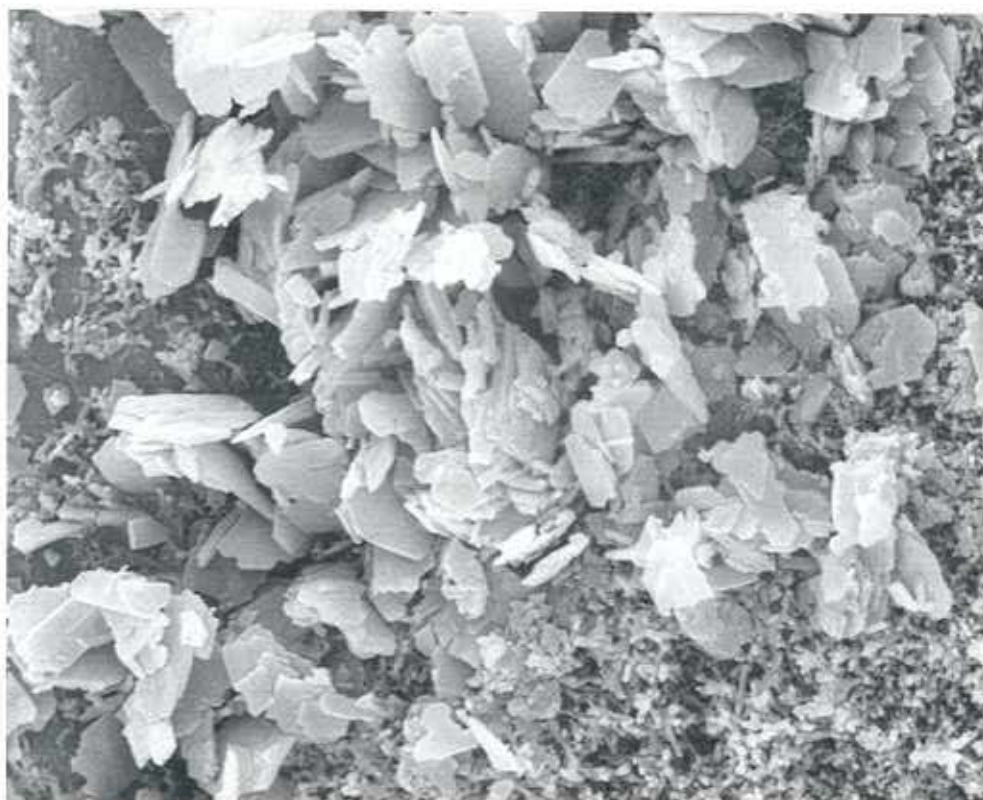
Abb. 19: PP. W 8/Wels, REM-Aufnahme eines Nadelbereiches mit zahlreichen Gipskristallen. Vergrößerung: 4400fach.
