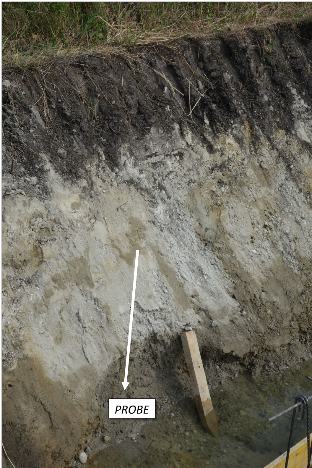
Abb. 2.2.3.13: Detailfoto in der Baugrube in Podersdorf am See mit Probenahmepunkt: im Hangenden ein schwarzbrauner Bodenhorizont; die Basis bilden hellgraue sandreiche Kiese (Foto: M. Peresson).
