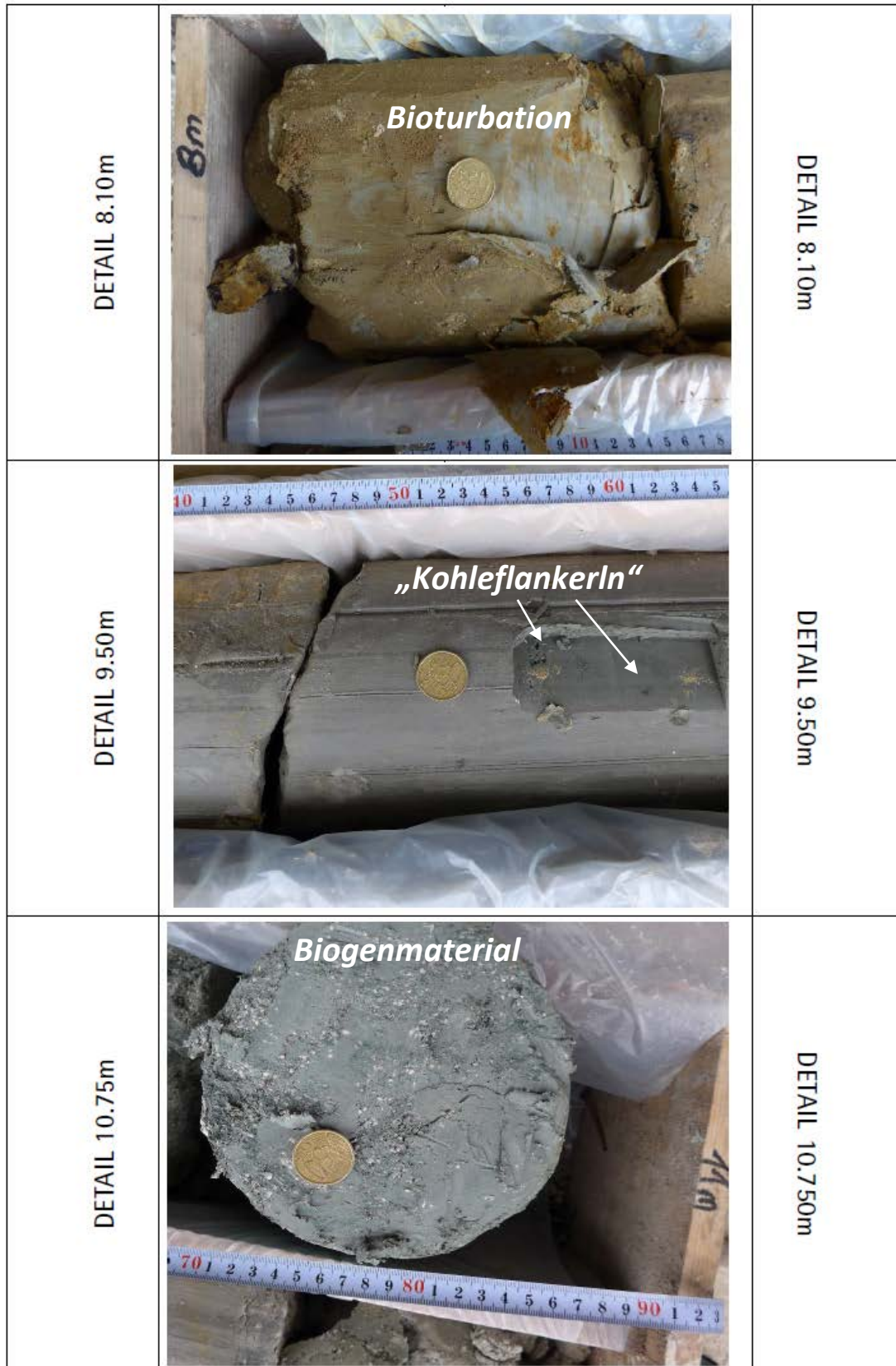
Abb. 2.3.1.9: Erkundungsbohrung EKB02 Bruckneudorf: Detailfotos der Bohrkern (Foto: G. Bieber, A. Römer).
