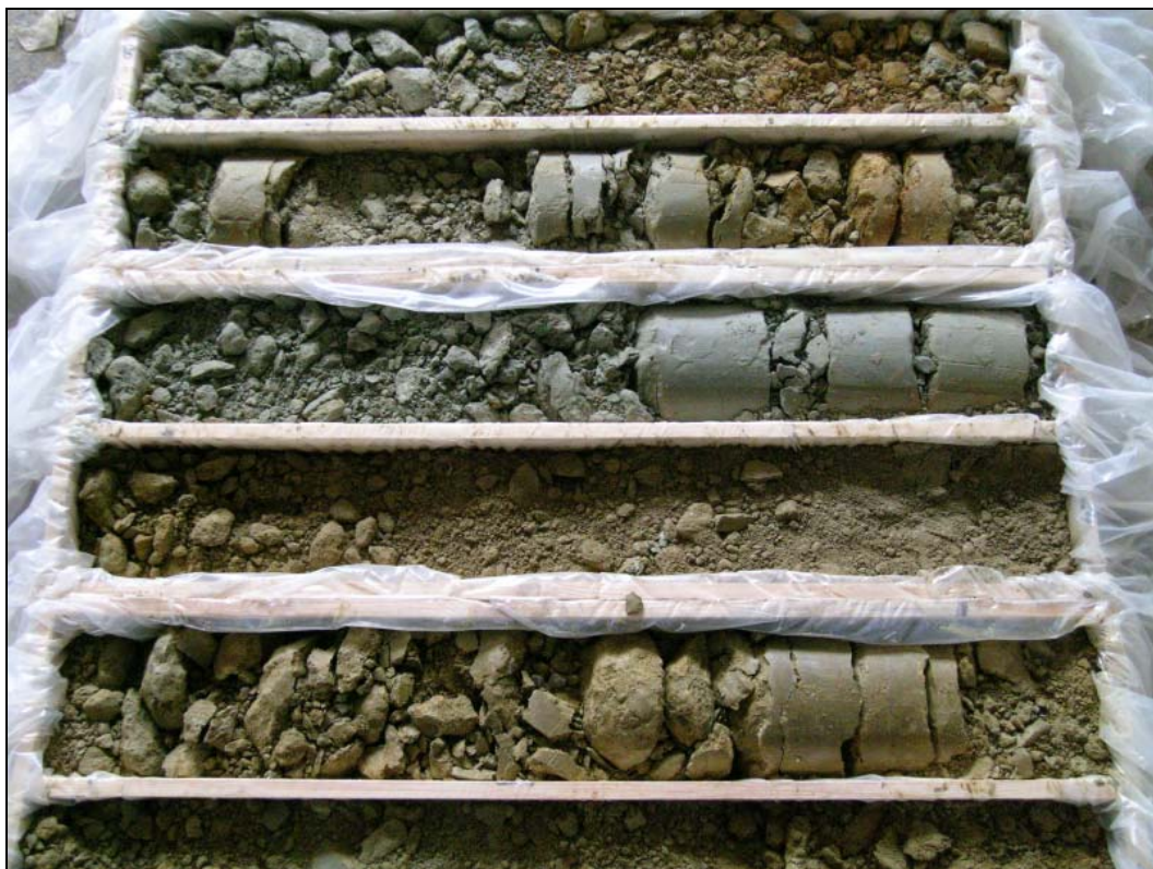
Abb. 55: S7 Fürstenfelder Schnellstraße, B-KB44/05: 20,0–25,0m – Neogene braune und graue schluffige Sande und tonige Schluffe
