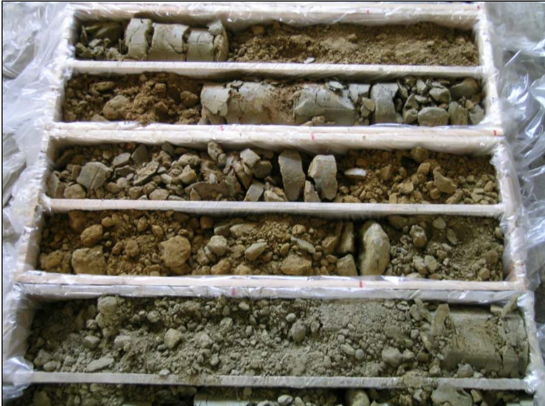
Abb. 78: S7 Fürstenfelder Schnellstraße, C-KB49/05: 20,0–25,0m – Neogene braune bis graue Schluffe, Sande und Tone
