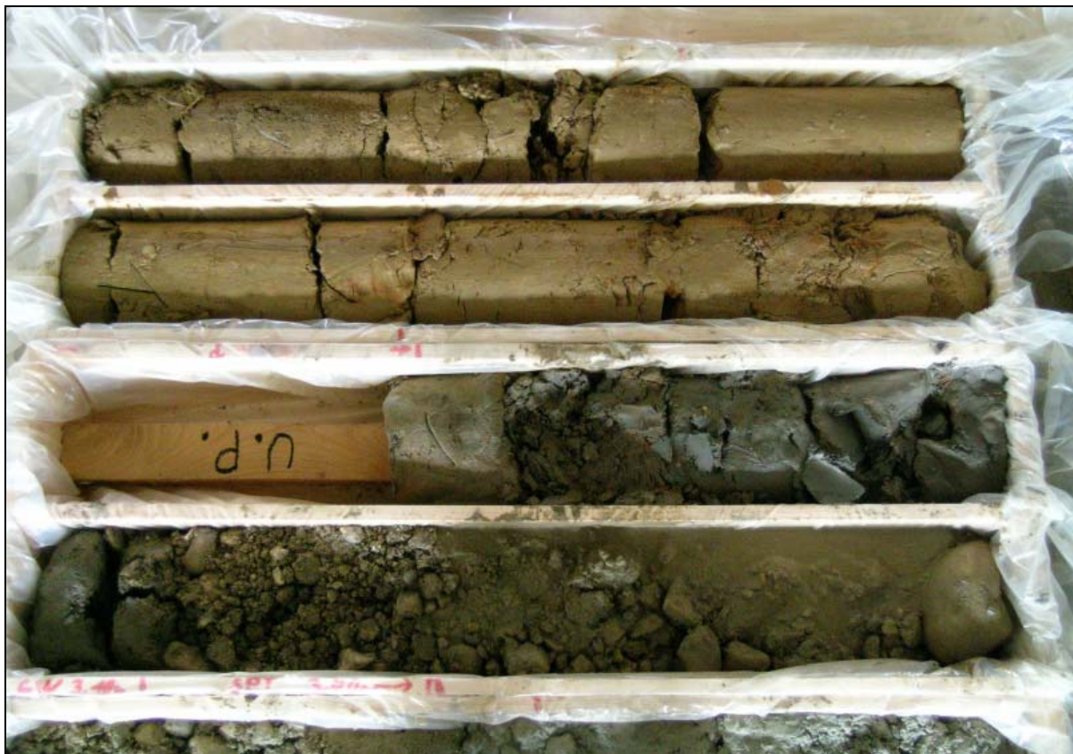
Abb. 69: S7 Fürstenfelder Schnellstraße, C-KB21/05: 0,0–4,0m – Quartäre braune und graue schluffige Tone
