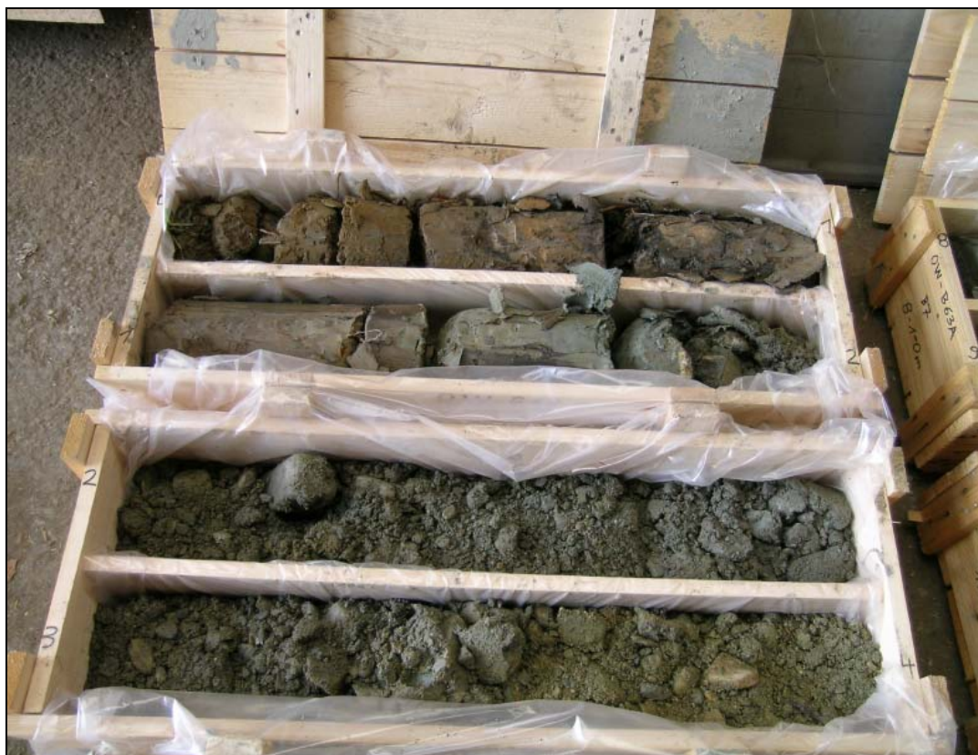
Abb. 8: Umfahrung Oberwart: KB7/05 (1,0–4,0m) – Abfolge aus quartären (?) Tonen („Aulehme“) und Kiesen
