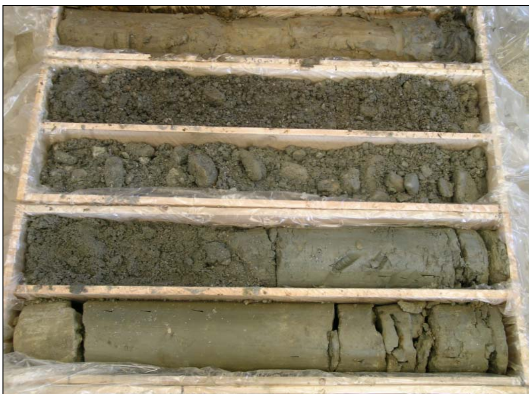
Abb. 99: S7 Fürstenfelder Schnellstraße, E-KB33/05: 3,0–8,0m – Braune bis graue quartäre Kiese und graubraune neogene Tone
