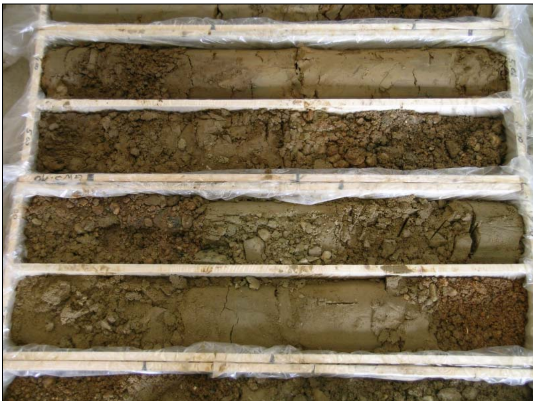
Abb. 93: S7 Fürstenfelder Schnellstraße, D-KB30/05: 4,0–8,0m – Quartäre braune und graue Schluffe und Kiese
