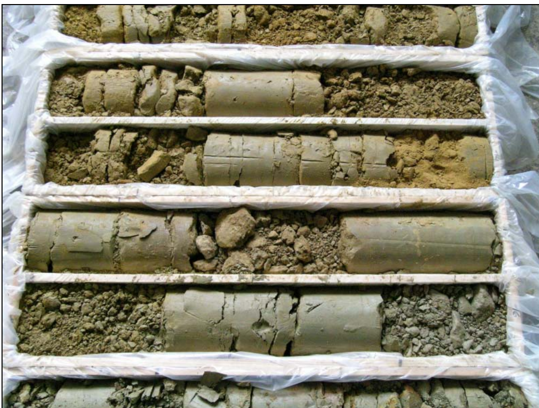
Abb. 53: S7 Fürstenfelder Schnellstraße, B-KB44/05: 11,0–16,0m – Neogene braune schluffige Sande und tonige Schluffe
