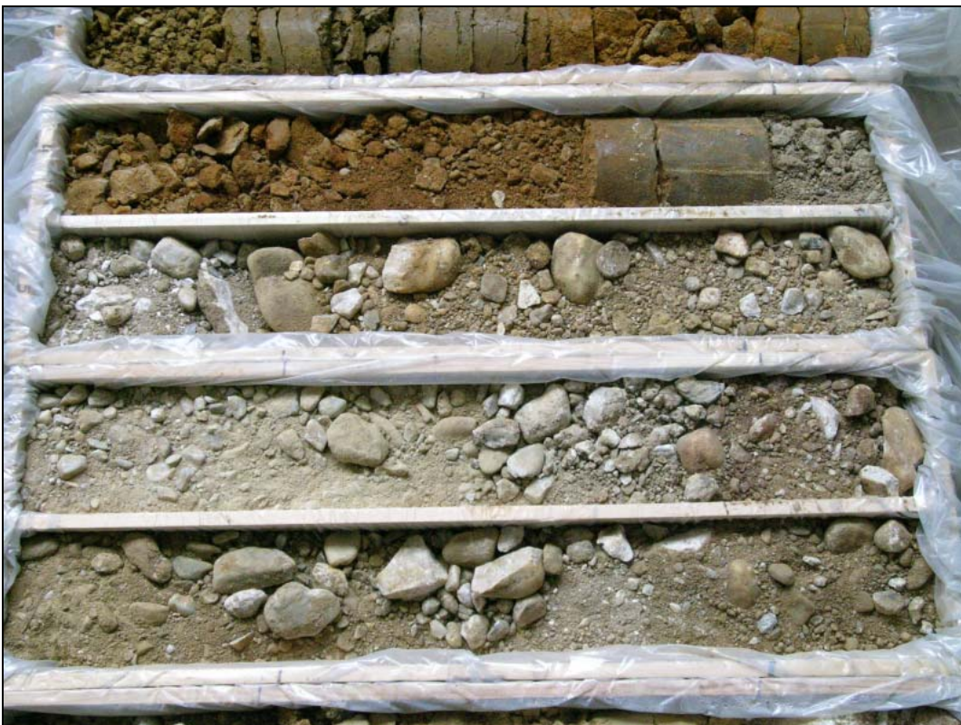
Abb. 51: S7 Fürstenfelder Schnellstraße, B-KB44/05: 4,0–8,0m – braune schluffige Tone und Grobkiese mit Blöcken
