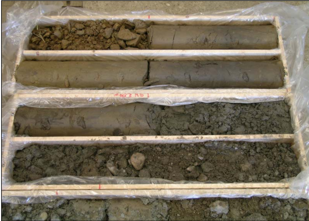
Abb. 102: S7 Fürstenfelder Schnellstraße, E-KB20/05: 0,0–4,0m – Braune bis dunkelbraune quartäre Tone und graubraune sandige Kiese
