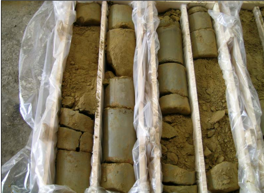
Abb. 6: Umfahrung Oberwart: KB1/05 (8,0–12,0m) – Abfolge aus rotbraunen neogenen Sanden und graubraunen Schluffen
