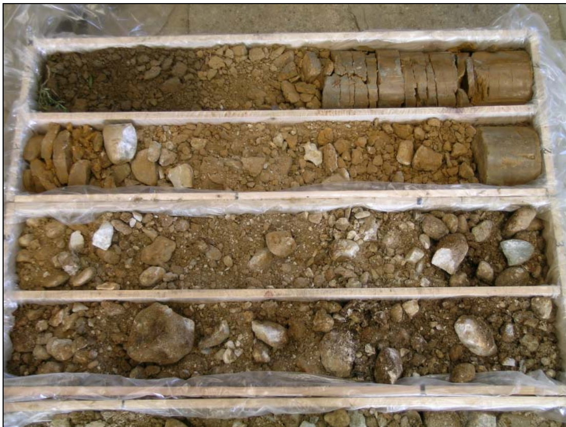
Abb. 25: S7 Fürstenfelder Schnellstraße – A-KB26/05: 0,0–4,0m – braune schluffig, tonige quartäre Grobkiese und Steine
