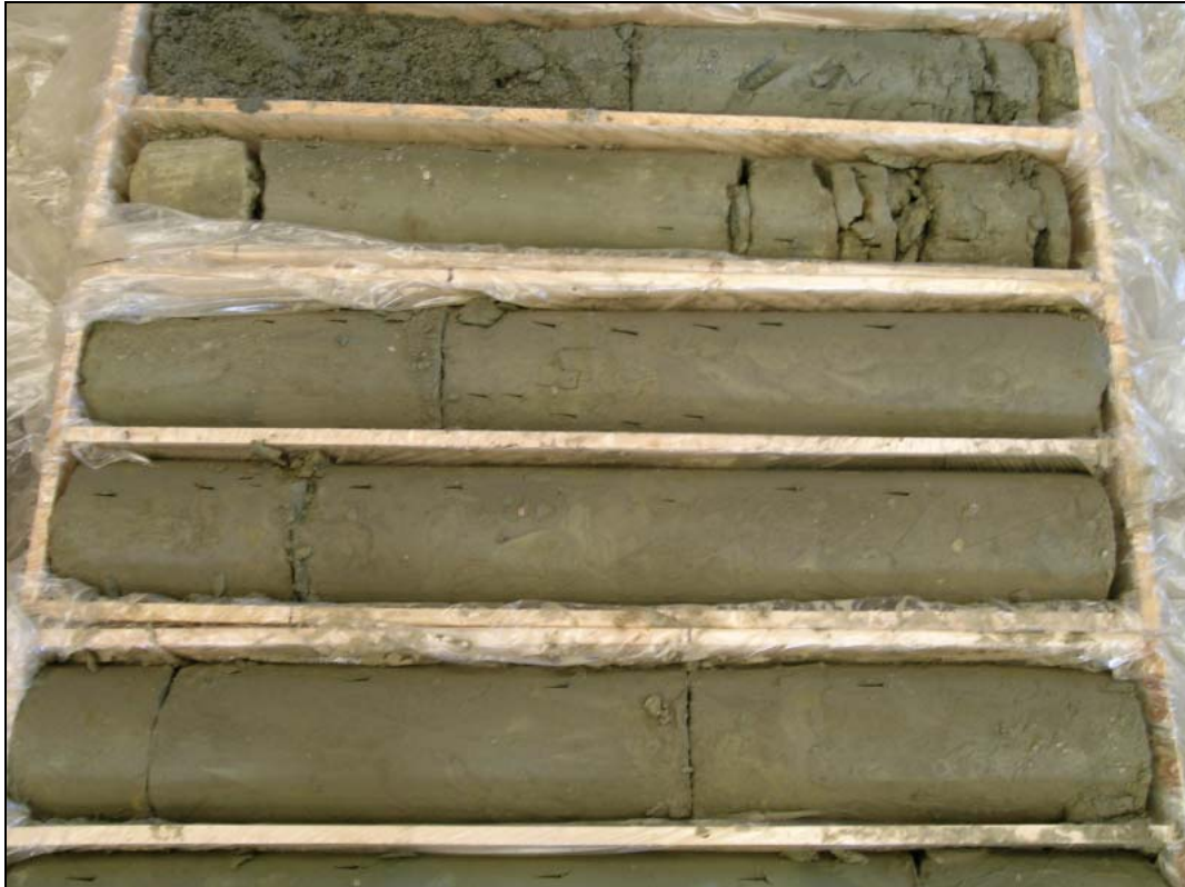
Abb. 100: S7 Fürstenfelder Schnellstraße, E-KB33/05: 6,0–11,0m – Braune bis graue quartäre Kiese und graubraune neogene Tone
