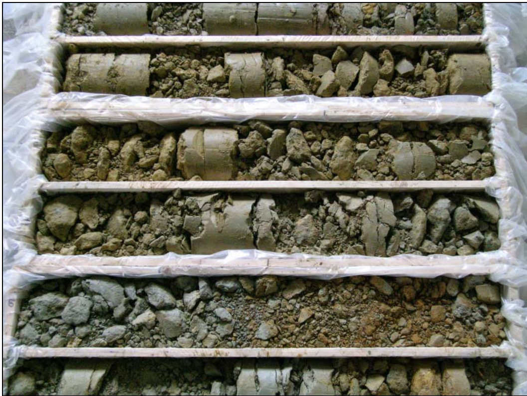
Abb. 54: S7 Fürstenfelder Schnellstraße, B-KB44/05: 16,0–21,0m – Neogene braune und graue schluffige Sande und tonige Schluffe
