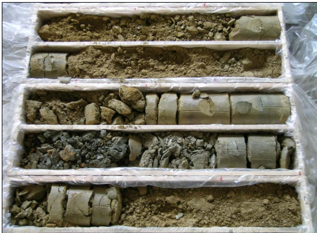
Abb. 77: S7 Fürstenfelder Schnellstraße, C-KB49/05: 16,0–21,0m – Neogene braune bis graue Schluffe, Sande und Tone
