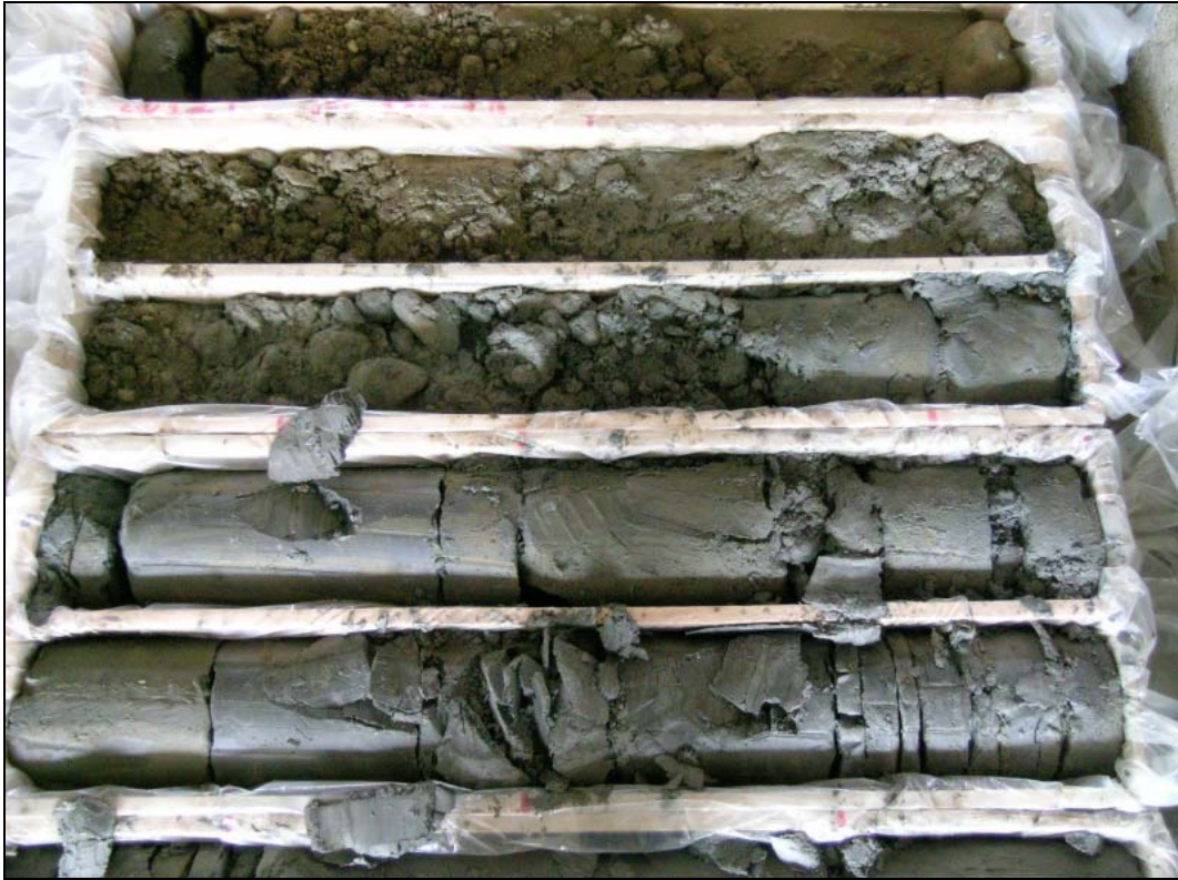
Abb. 70: S7 Fürstenfelder Schnellstraße, C-KB21/05: 3,0–8,0m – Quartäre grobraune Grobkiese und Steine, gefolgt von neogenen grauen Tonen
