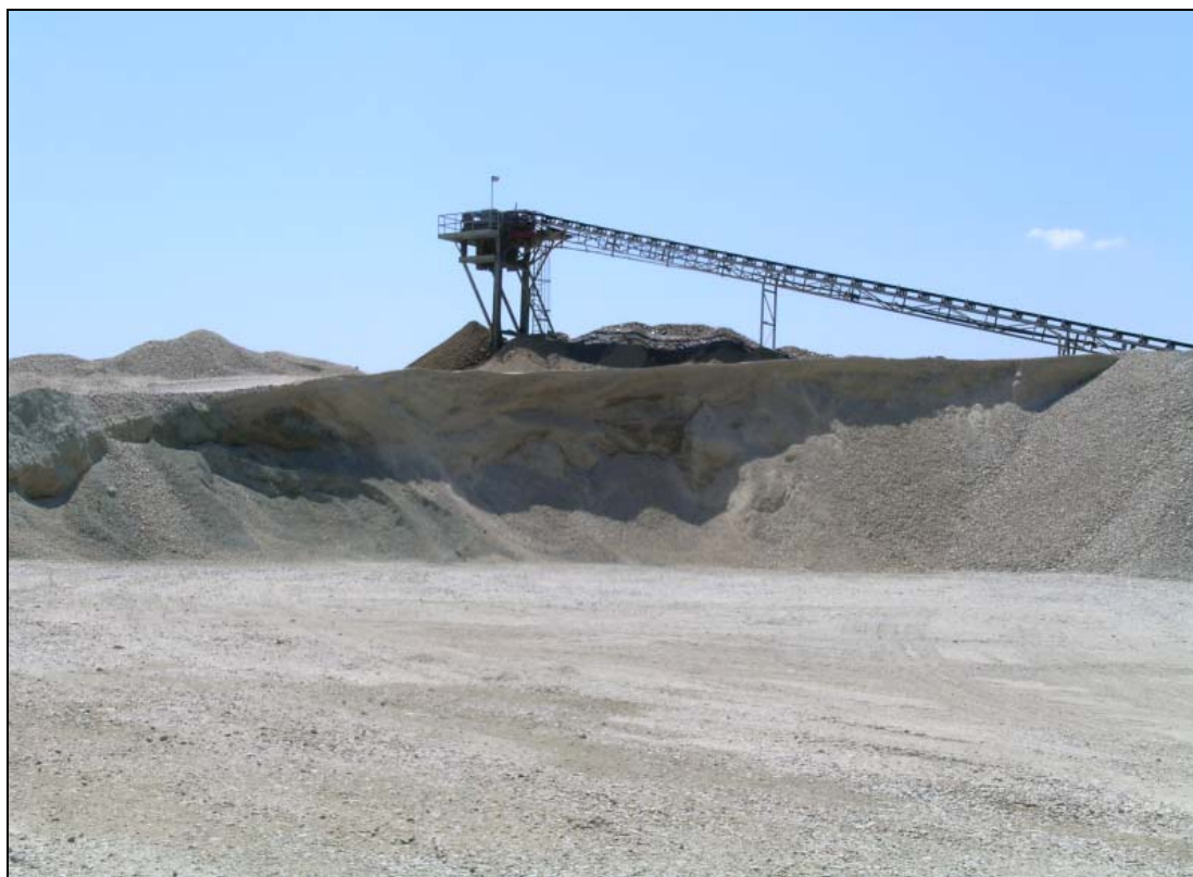
Abb. 112: Schotterwerk Holler, mobile Sieb- und Brecheranlage (02/08/2005)
