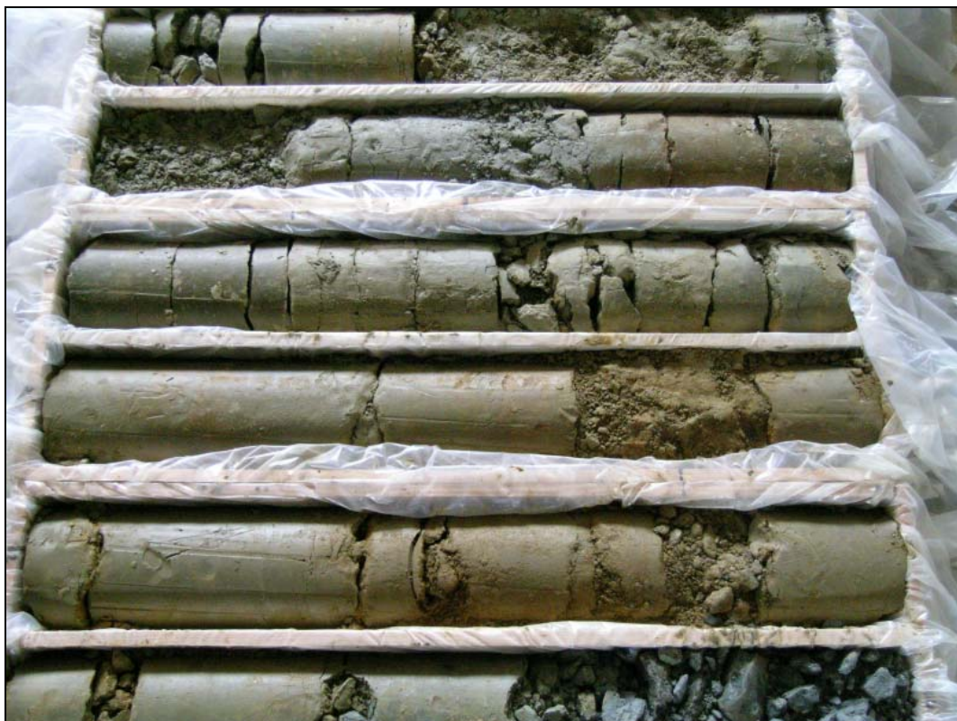
Abb. 57: S7 Fürstenfelder Schnellstraße, B-KB44/05: 28,0–33,0m – Neogene braune und graue schluffige Sande und tonige Schluffe
