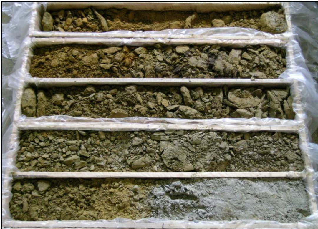
Abb. 40: S7 Fürstenfelder Schnellstraße, B-KB46/05: 15,0–20,0m – braune und graue neogene tonige Schluffe und Sande
