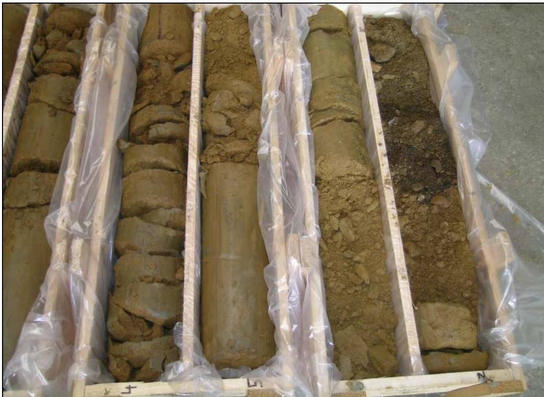
Abb. 14: Umfahrung Oberwart: KB4/05 (4,0–8,0m) – Abfolge aus ockerbraunen quartären (?) Schluffen, Tonen und Sanden („Aulehme“) und Kiese
