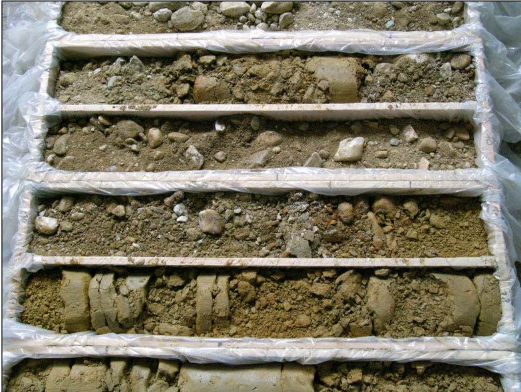
Abb. 52: S7 Fürstenfelder Schnellstraße, B-KB44/05: 8,0–12,0m – braune Grobkiese mit Blöcken und neogene? braune schluffige Sande
