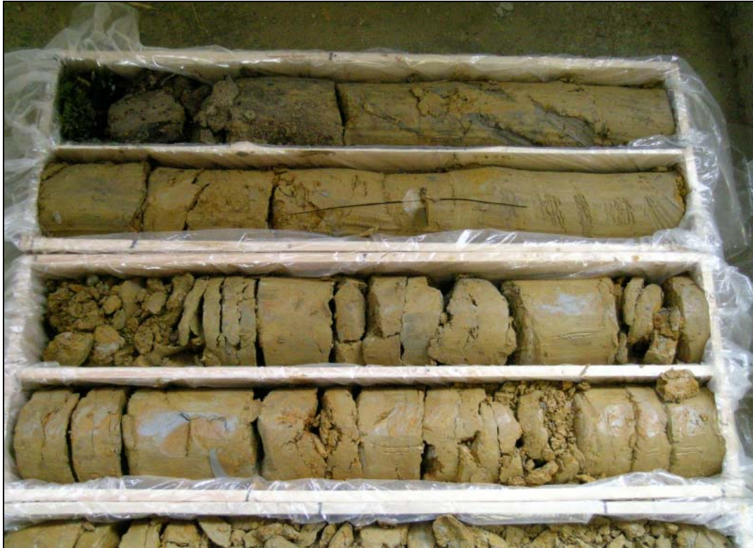
Abb. 36: S7 Fürstenfelder Schnellstraße, B-KB46/05: 0,0–4,0m – schwarzbraune bis graubraune quartäre schluffige Tone
