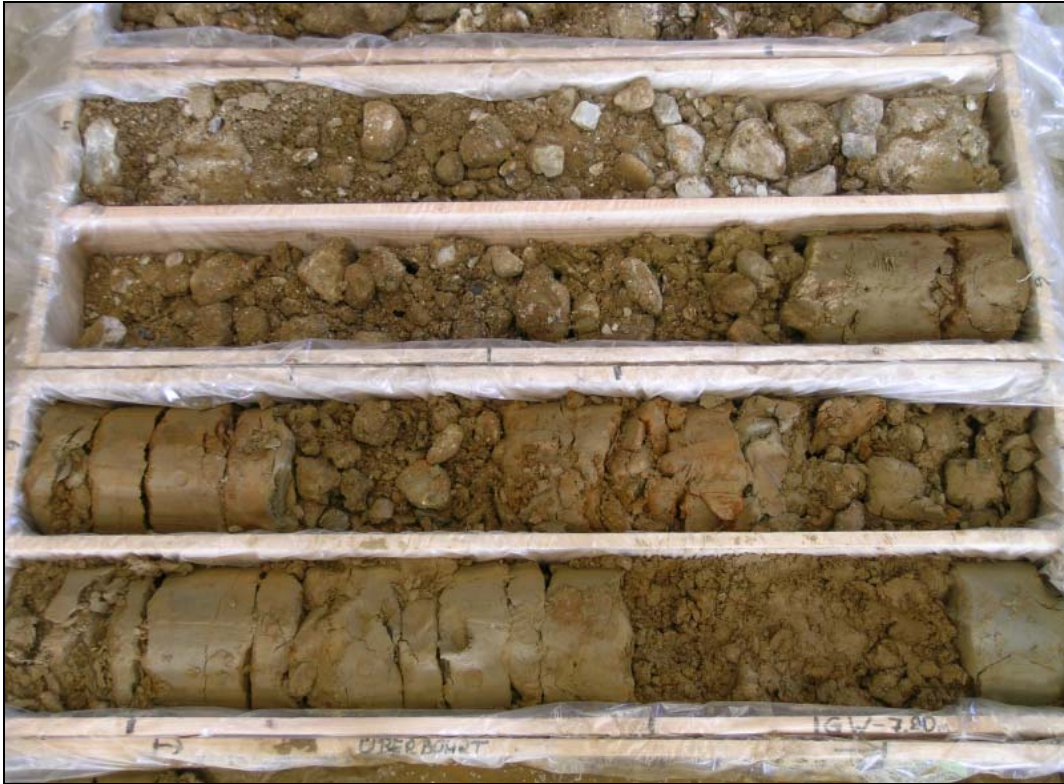
Abb. 26: S7 Fürstenfelder Schnellstraße – A-KB26/05: 4,0–8,0m – Quartäre Grobkiese und Steine, unterlagert von rotbraunen neogenen Sanden
