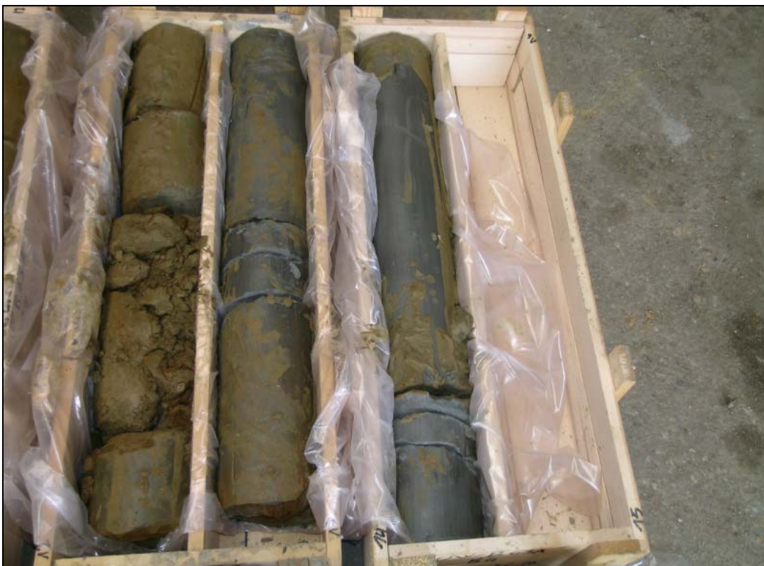
Abb. 16: Umfahrung Oberwart: KB4/05 (12,0–15,0m) – Abfolge aus blaugrauen Tonen und Schluffen des Pannonium
