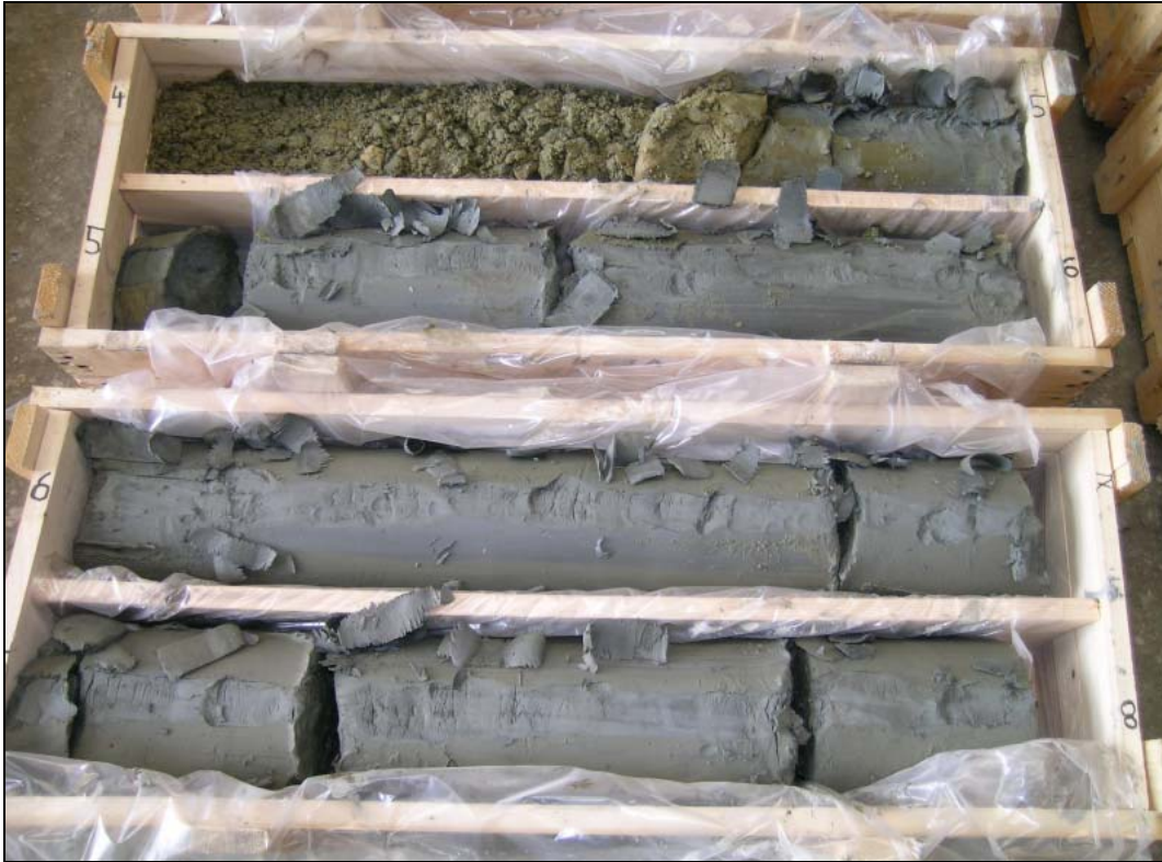
Abb. 9: Umfahrung Oberwart: KB7/05 (4,0–8,0m) – Abfolge aus quartären (?) Kiesen und blaugrauen Schluffen und Tonen des Pannonium
