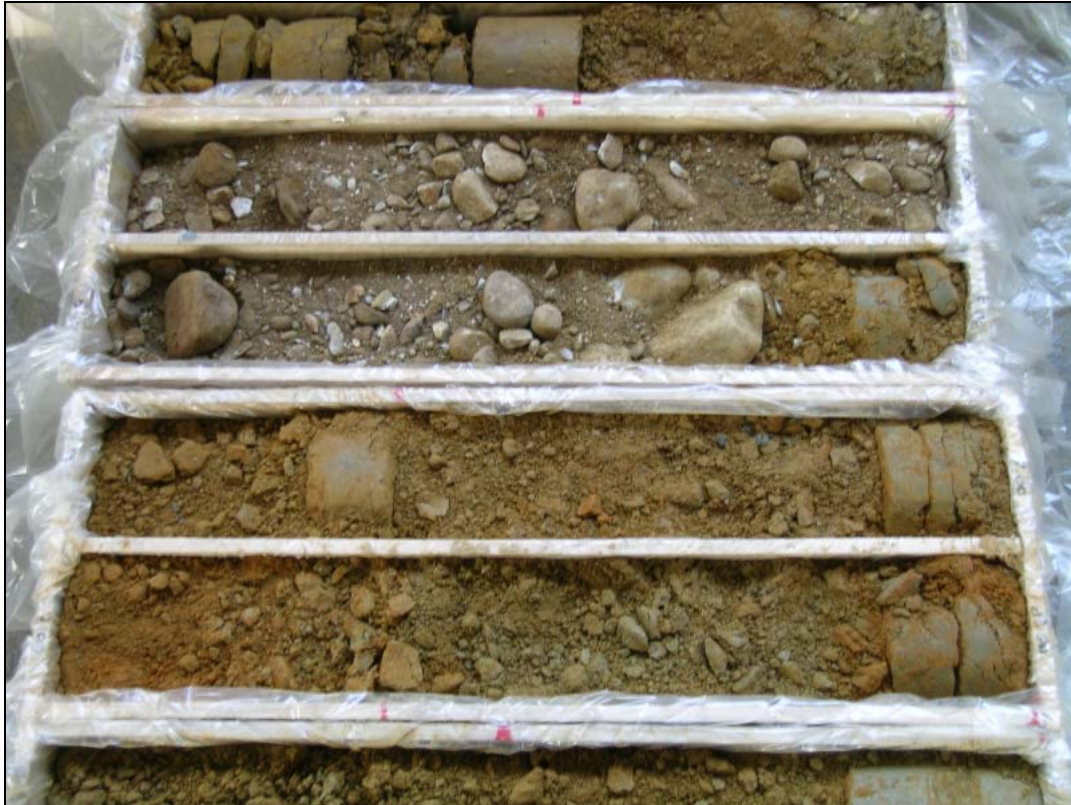
Abb. 30: S7 Fürstenfelder Schnellstraße, A-KB36/05: 4,0–8,0m – Quartäre braune Grobschotter und Steine und neogene? rotbraune Sande
