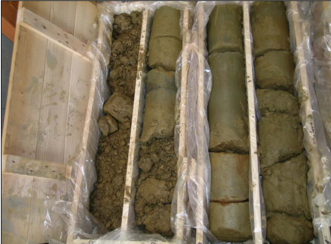
Abb. 15: Umfahrung Oberwart: KB4/05 (8,0–12,0m) – Abfolge aus ockerbraunen quartären (?) Kiesen und Schluffen des Pannonium
