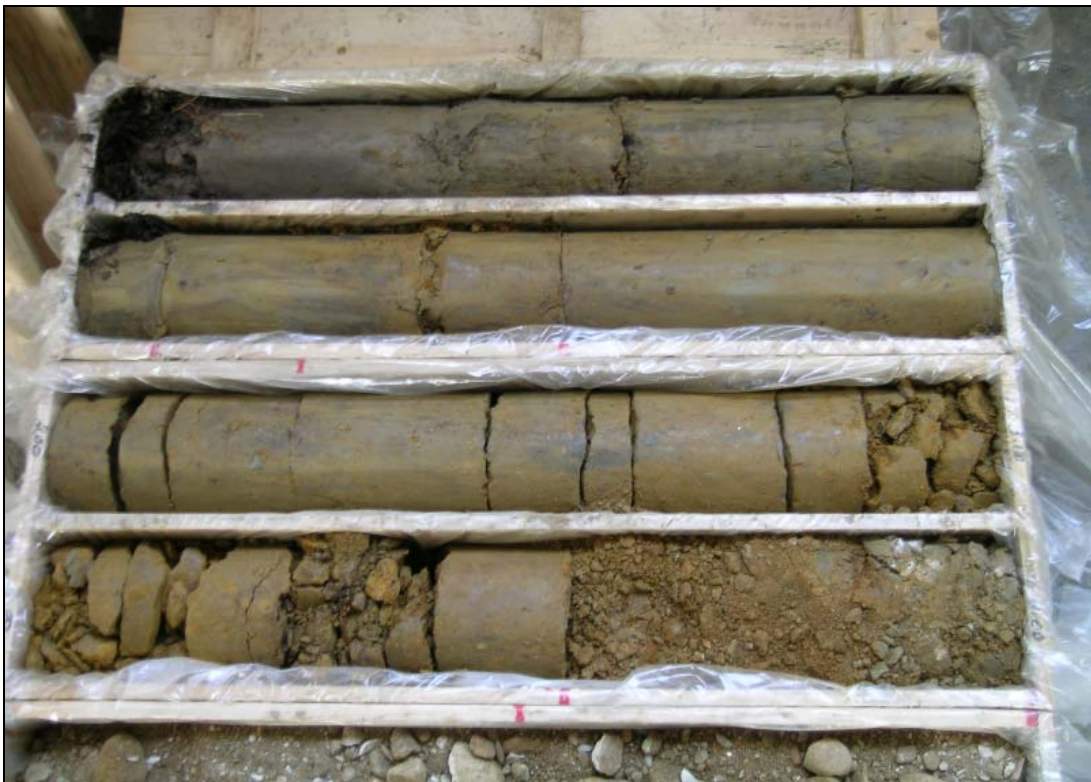
Abb. 29: S7 Fürstenfelder Schnellstraße, A-KB36/05: 0,0–4,0m – Quartäre graue bis braune Tone und Schluffe
