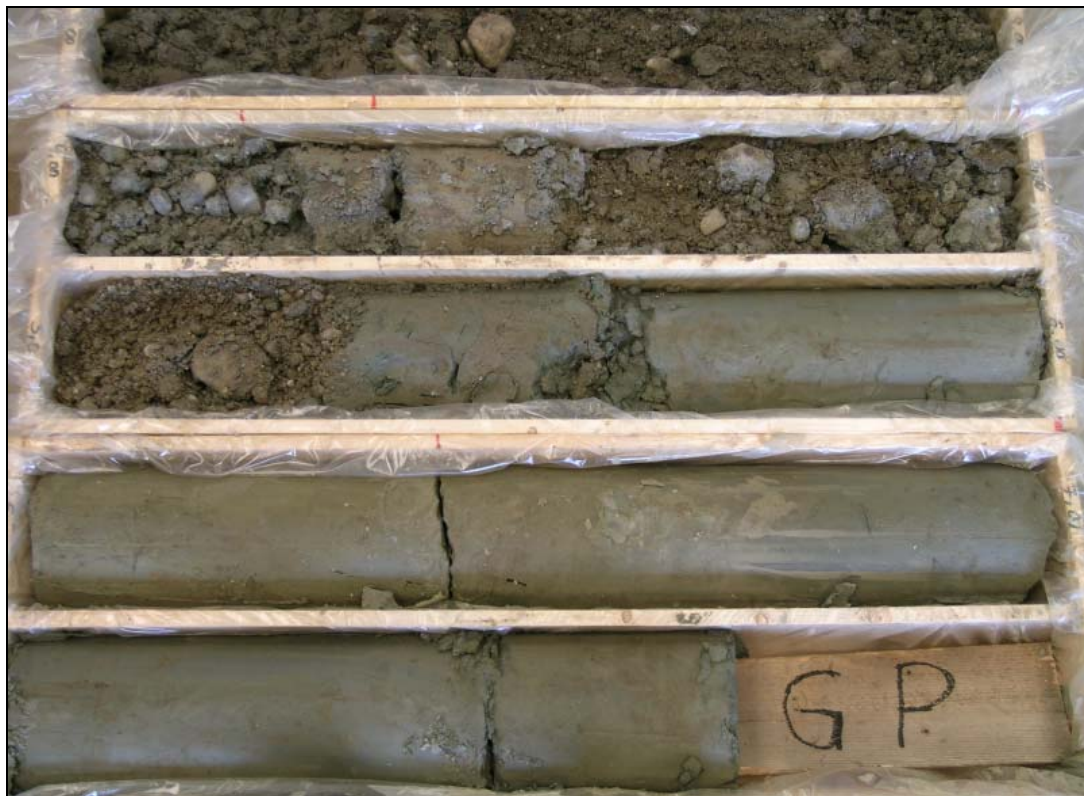
Abb. 103: S7 Fürstenfelder Schnellstraße, E-KB20/05: 4,0–8,0m – Braune bis dunkelbraune quartäre sandige Kiese und graue neogene Tone
