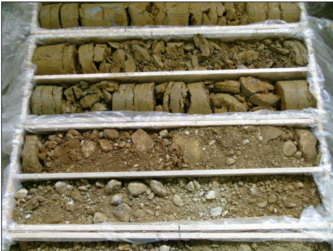
Abb. 37: S7 Fürstenfelder Schnellstraße, B-KB46/05: 3,0–8,0m – braune schluffige quartäre Tone und Steine und Kiese
