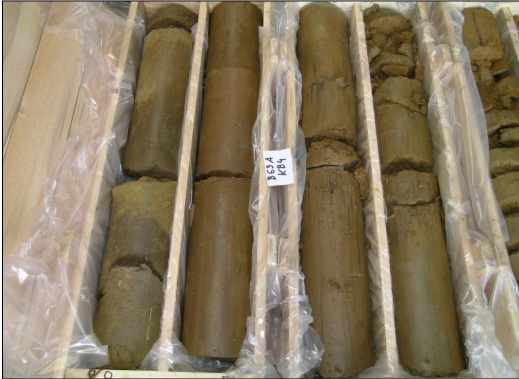
Abb. 13: Umfahrung Oberwart: KB4/05 (0,0–4,0m) – Abfolge aus ockerbraunen quartären Schluffen und Tonen („Aulehme“)
