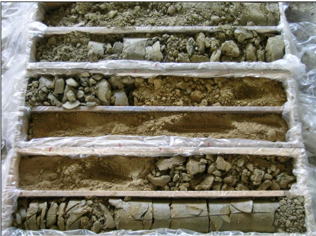
Abb. 79: S7 Fürstenfelder Schnellstraße, C-KB49/05: 24,0–30,0m – Neogene braune bis graue Schluffe, Sande und Tone
