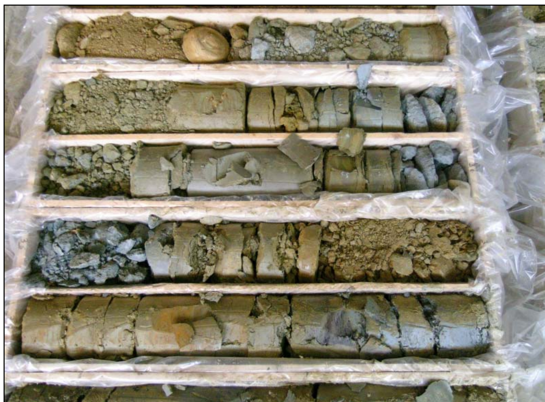
Abb. 45: S7 Fürstenfelder Schnellstraße, B-KB46/05: 33,0–38,0m – braune und graue neogene Sande und Schluffe
