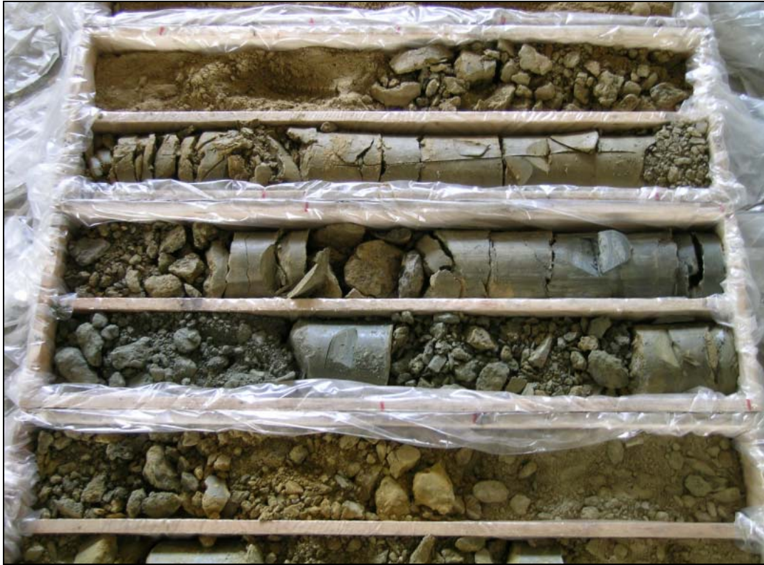
Abb. 80: S7 Fürstenfelder Schnellstraße, C-KB49/05: 28,0–33,0m – Neogene braune bis graue Schluffe, Sande und Tone
