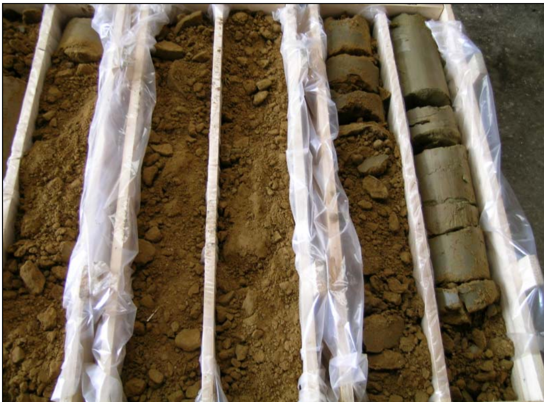
Abb. 5: Umfahrung Oberwart: KB1/05 (3,0–8,0m) – Abfolge aus rotbraunen neogenen Sanden und grauen Tonen bzw. Schluffen
