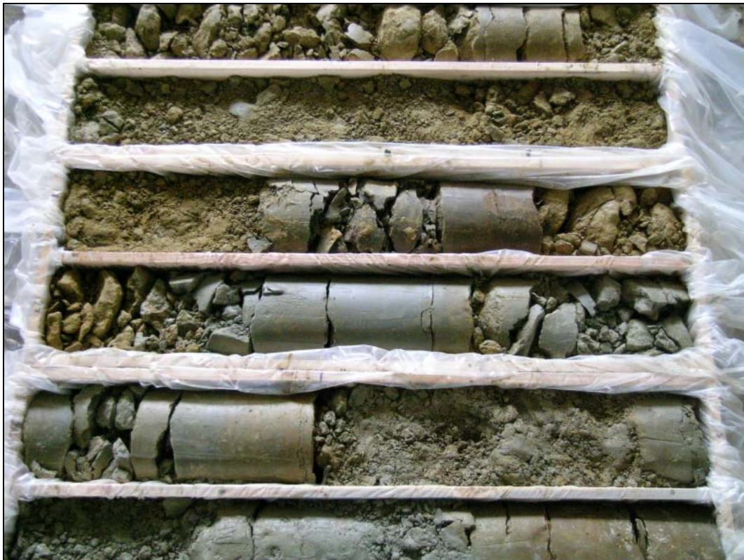
Abb. 56: S7 Fürstenfelder Schnellstraße, B-KB44/05: 25,0–29,0m – Neogene braune und graue schluffige Sande und tonige Schluffe
