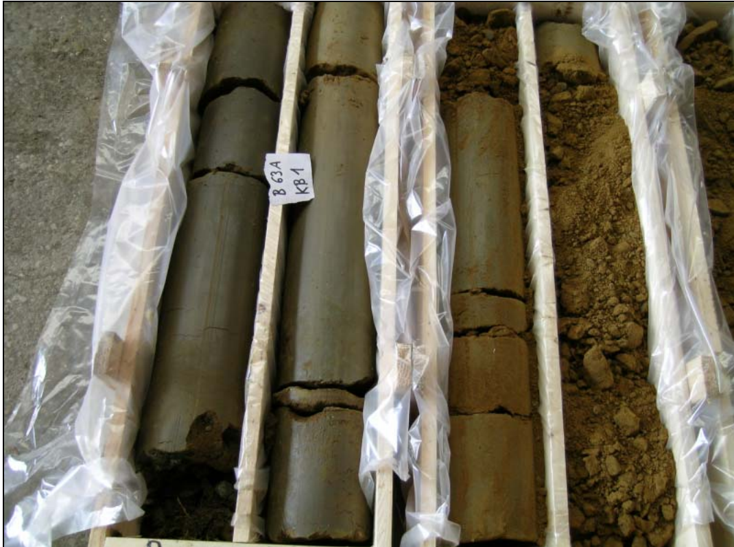
Abb. 4: Umfahrung Oberwart: KB1/05 (0,0–4,0m) – Abfolge aus grauen neogenen Tonen bzw. Schluffen und rotbraunen Sanden
