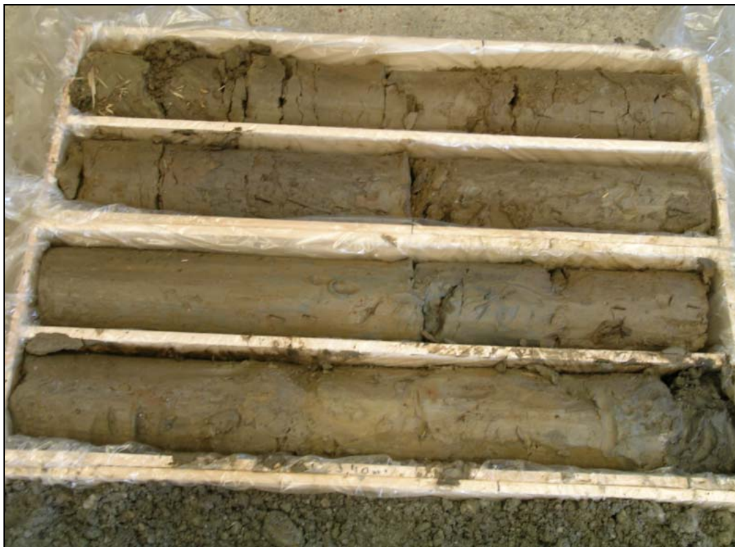
Abb. 98: S7 Fürstenfelder Schnellstraße, E-KB33/05: 0,0–4,0m – Braune bis graubraune schluffige quartäre Tone
