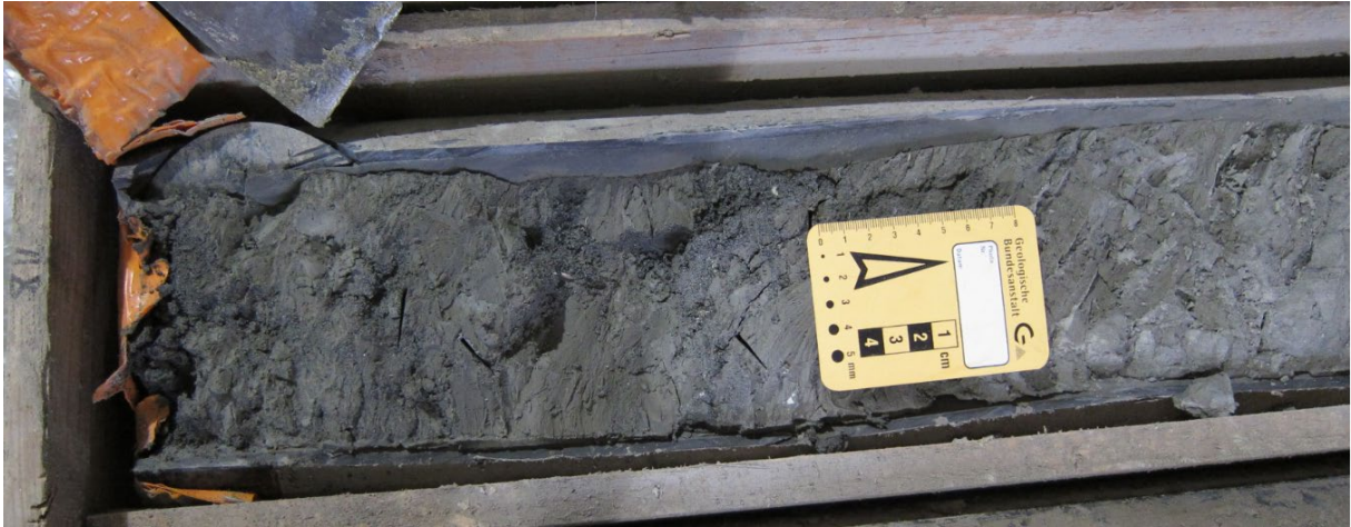
Abb. 2.1.1.24a.: Bohrkerndokumentation KB8 – Detailaufnahme zwischen 18m-19m: Schalenbruchstücke (Foto: M. Peresson).
