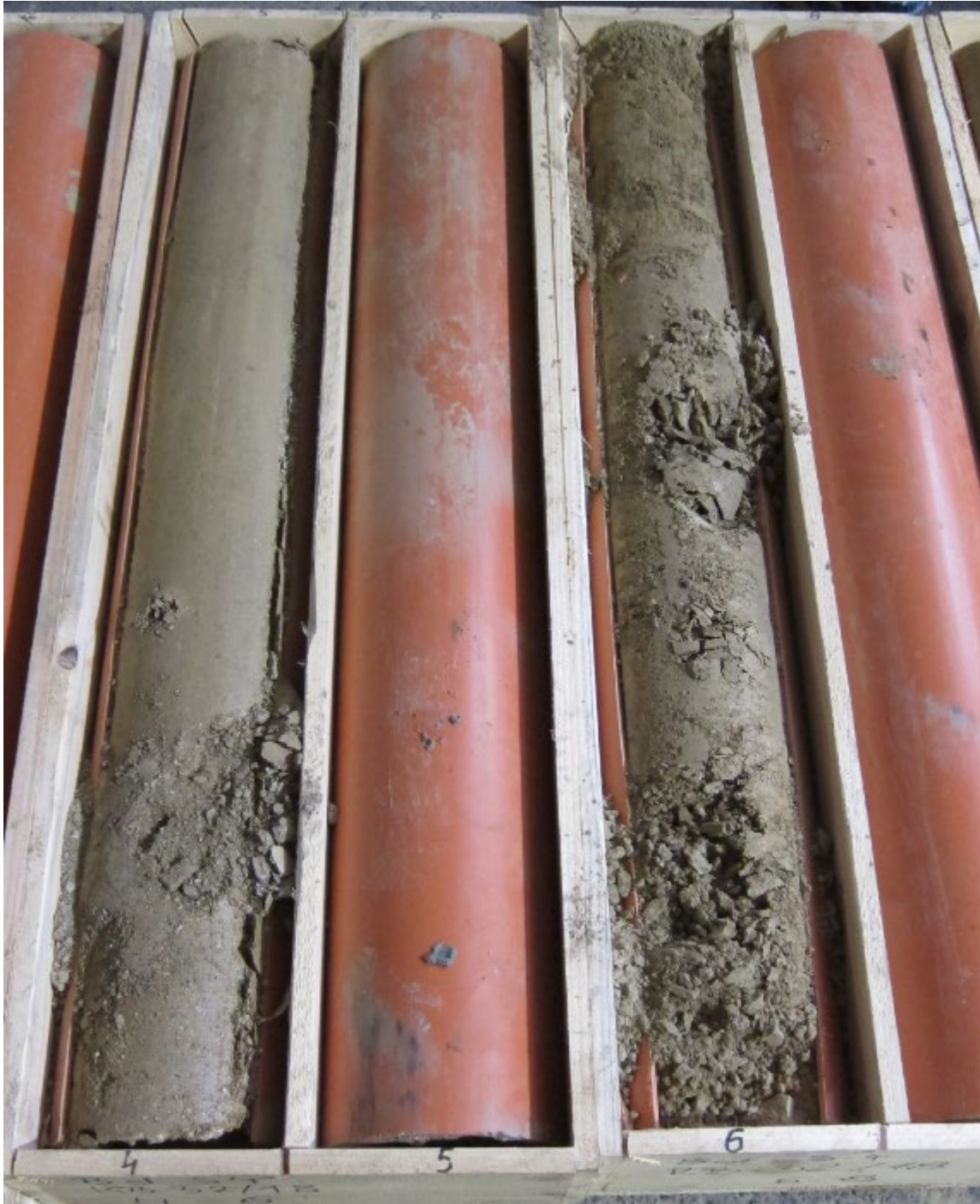
Abb. 2.1.1.43.: Bohrkerndokumentation KB32 (4,0-8,0m) (Foto: M. Peresson).
