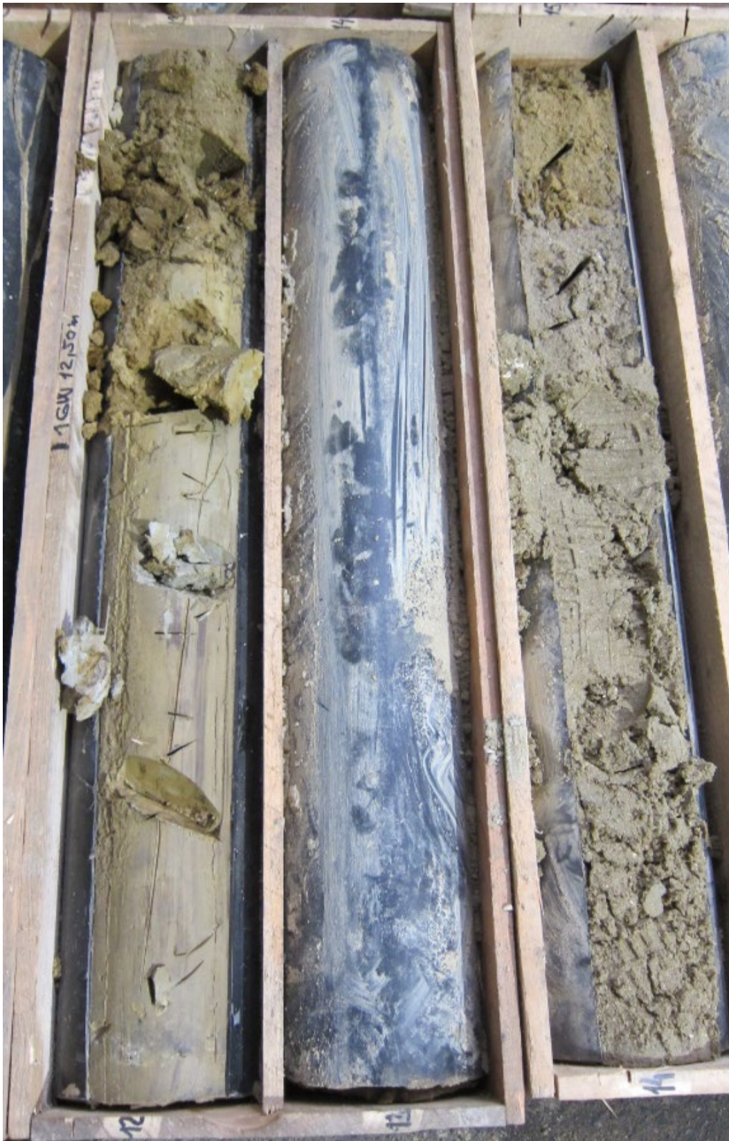
Abb. 2.1.1.31.: Bohrkerndokumentation KB17 (12,0-15,0m) (Foto: M. Peresson).
