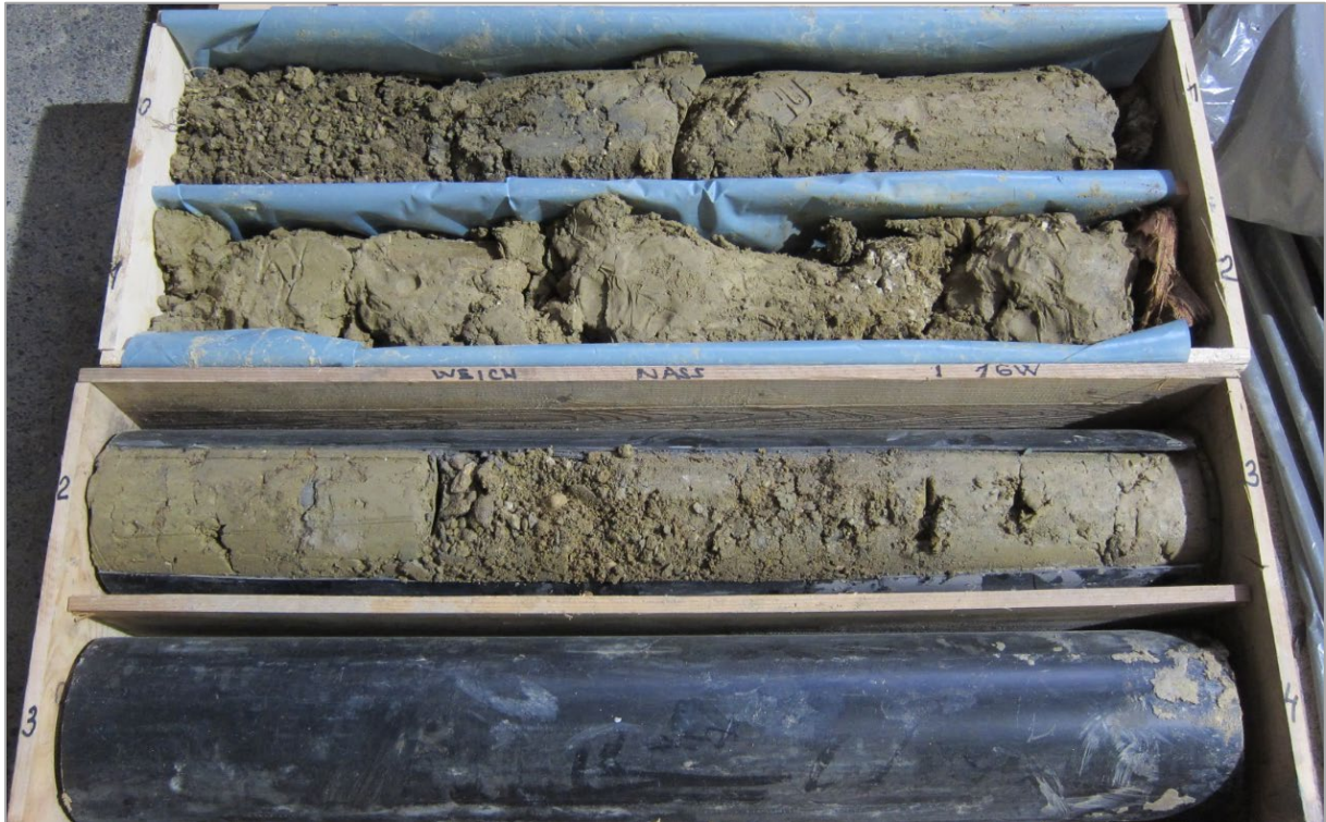
Abb. 2.1.1.7.: Bohrkerndokumentation KB4 (0,0-4,0m) (Foto: M. Peresson).
