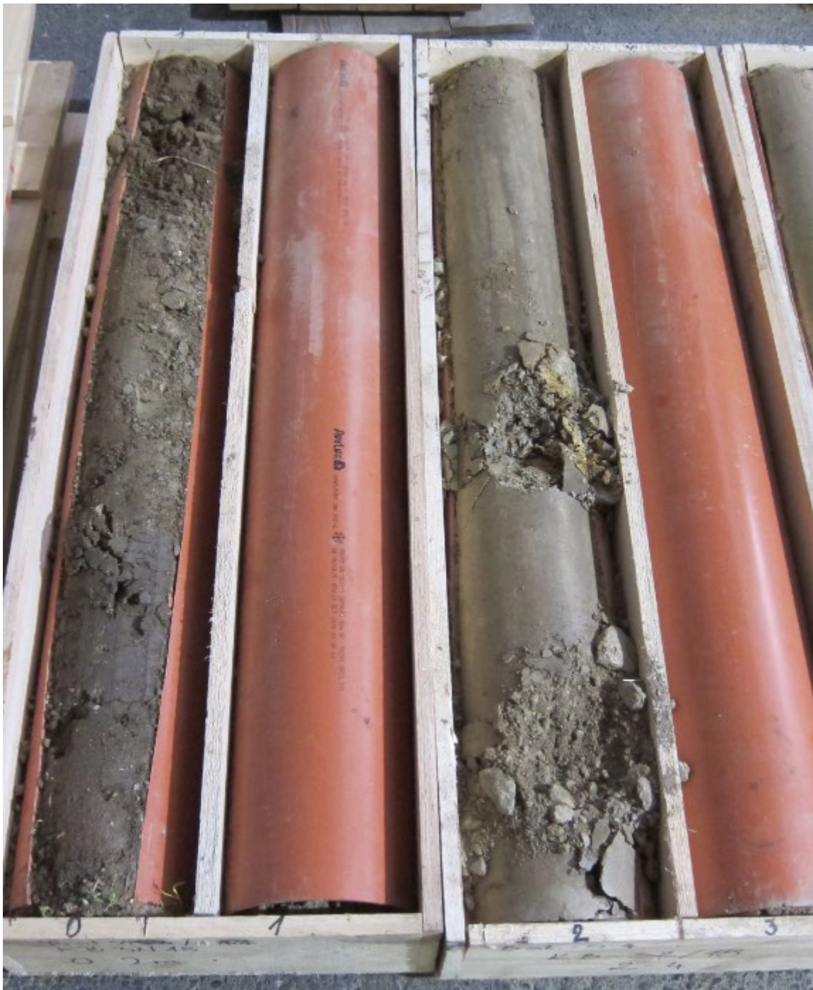
Abb. 2.1.1.42.: Bohrkerndokumentation KB32 (0,0-4,0m) (Foto: M. Peresson).
