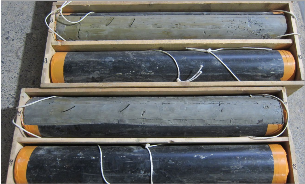
Abb. 2.1.1.9.: Bohrkerndokumentation KB4 (8,0-12,0m) (Foto: M. Peresson).
