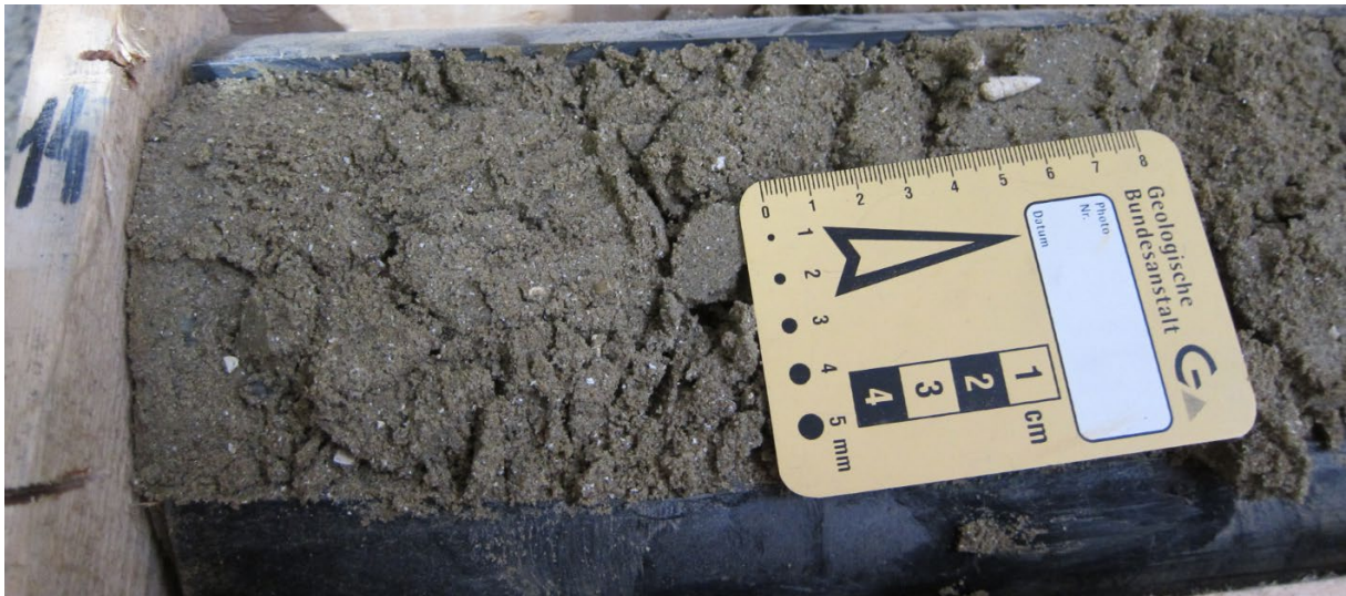
Abb. 2.1.1.38.: Bohrkerndokumentation KB17- Detailaufnahme bei 14,0m: Gastropodenbruchstücke und gut erhaltenen Formen (Foto: M. Peresson).
