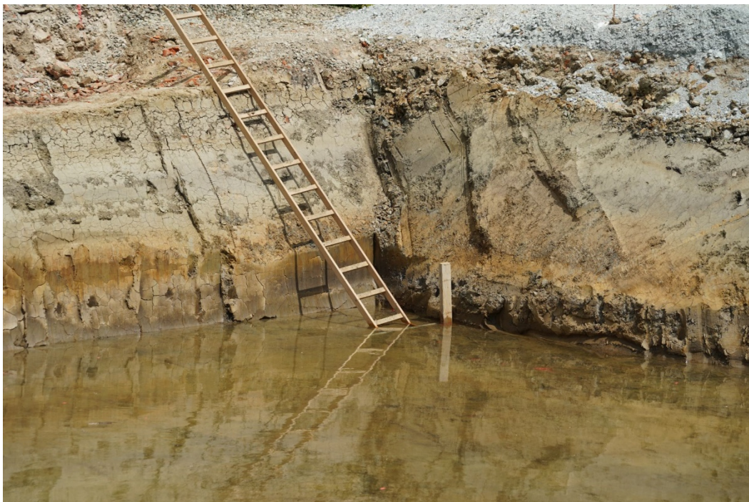
Abb. 2.3.1.12.: Baustelle für ein Tageszentrum in Kohfidisch: Abfolge aus Schluffen und Tonen in wechselnden Farbnuancen - Überflutungssedimente (Foto: M. Peresson).
