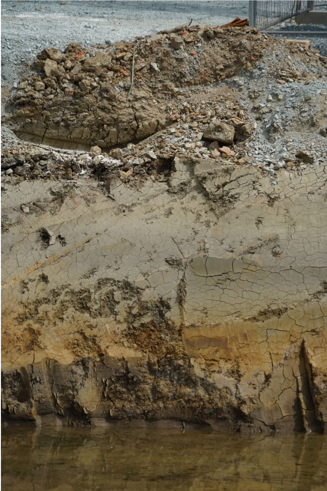
Abb. 2.3.1.17.: Baustelle für ein Tageszentrum in Kohfidisch: Abfolge aus Schluffen und Tonen in wechselnden Farbnuancen – Überflutungssedimente; innerhalb der rötlichen Schluffe Einschaltungen von Kieslinsen (Foto: M. Peresson).
