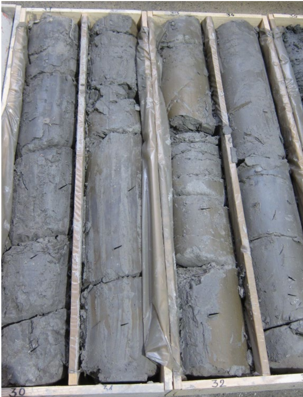
Abb. 2.1.1.47.: Bohrkerndokumentation KB32 (30,0-34,0m) (Foto: M. Peresson).
