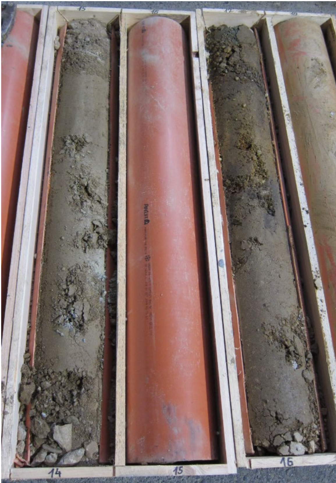
Abb. 2.1.1.44.: Bohrkerndokumentation KB32 (14,0-18,0m) (Foto: M. Peresson).
