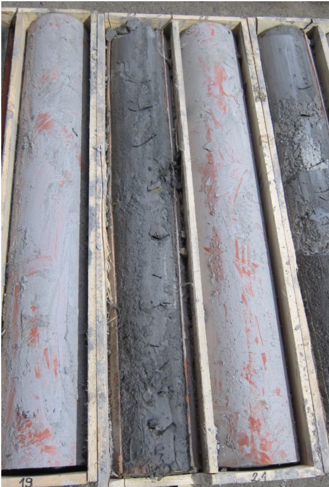
Abb. 2.1.1.46.: Bohrkerndokumentation KB32 (19,0-23,0m) (Foto: M. Peresson).
