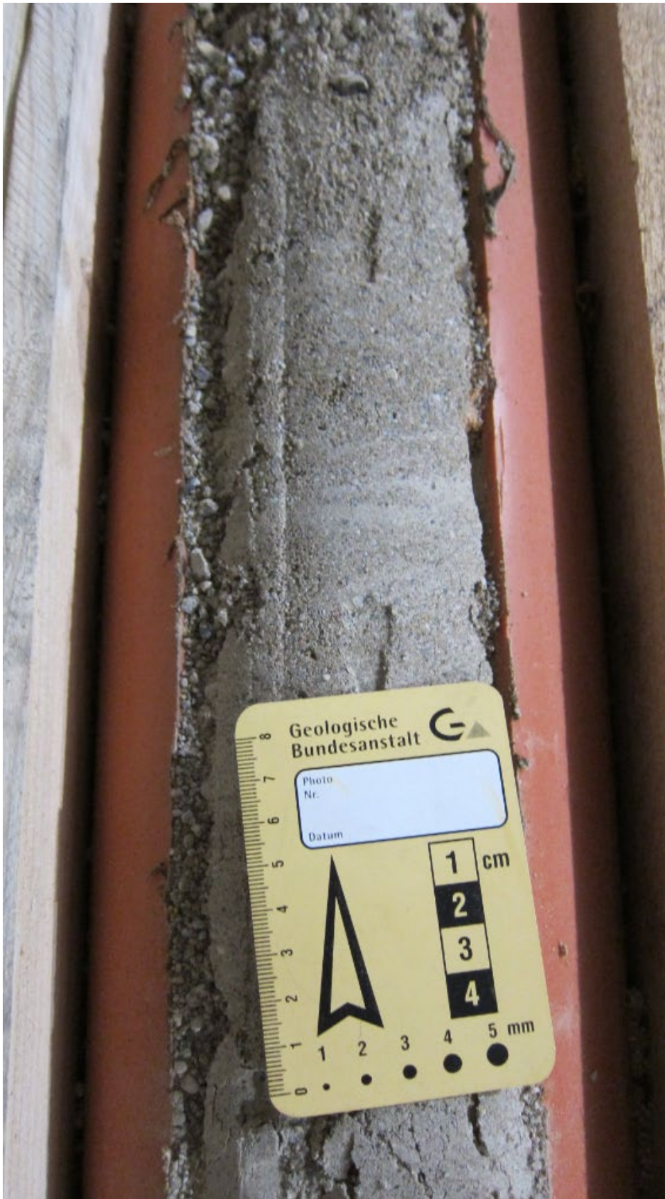
Abb. 2.1.1.53.: Bohrkerndokumentation KB68 (13,0-14,0m) - Detailaufnahme; Bioturbation innerhalb der Sandlagen (Foto: M. Peresson).
