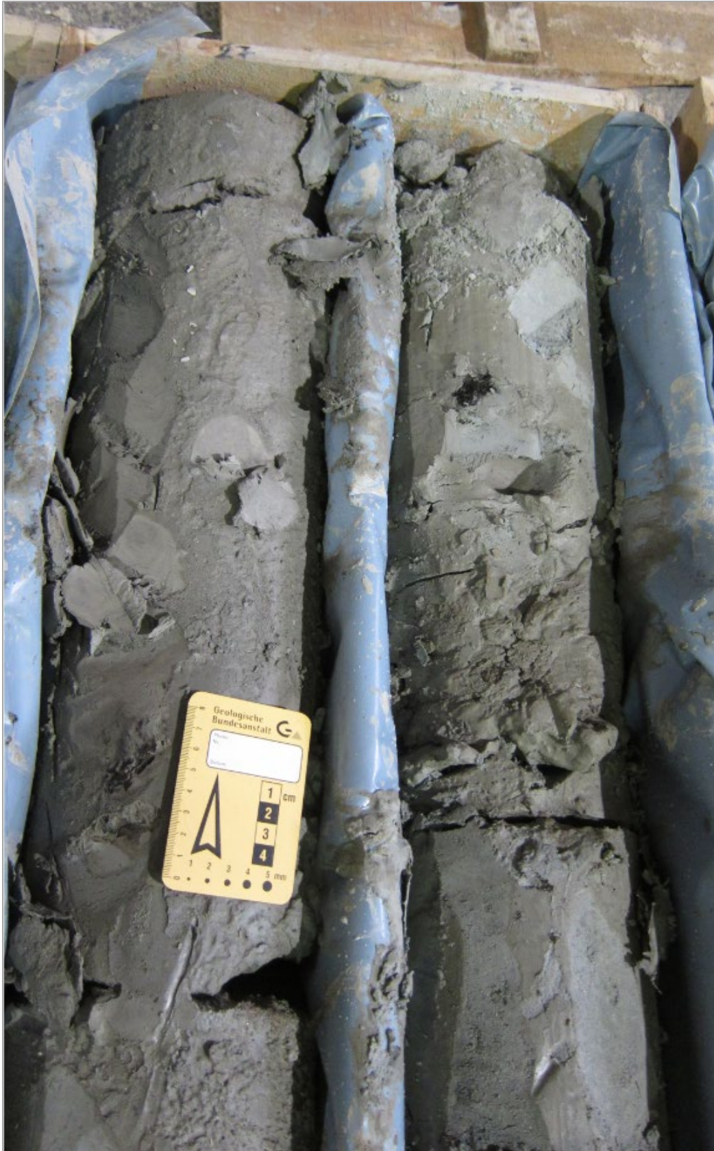
Abb. 2.1.1.23.: Bohrkerndokumentation KB8 – Detailaufnahme zwischen 26m-28m: Einlagerung von Kohleresten (Foto: M. Peresson).
