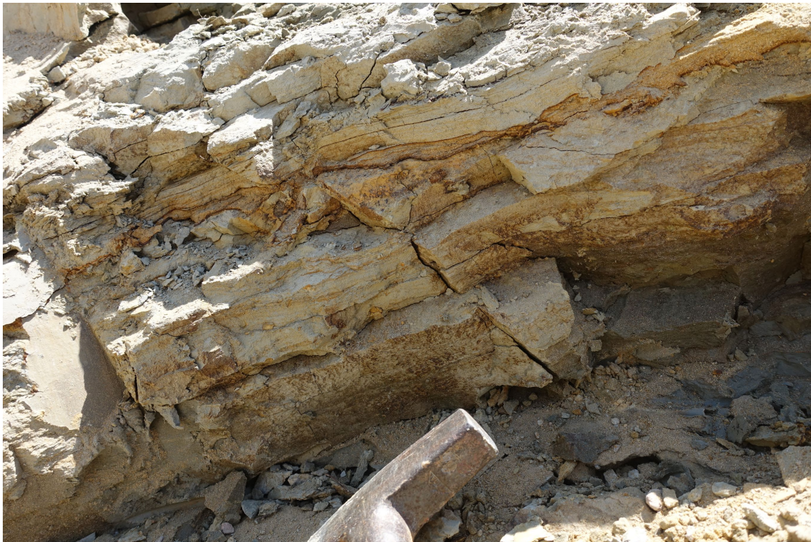
Abb. 2.2.1.20.: Schichtungseinfallen im „Bereich B“ sowie kleinmaßstäbliche Klüftung.
