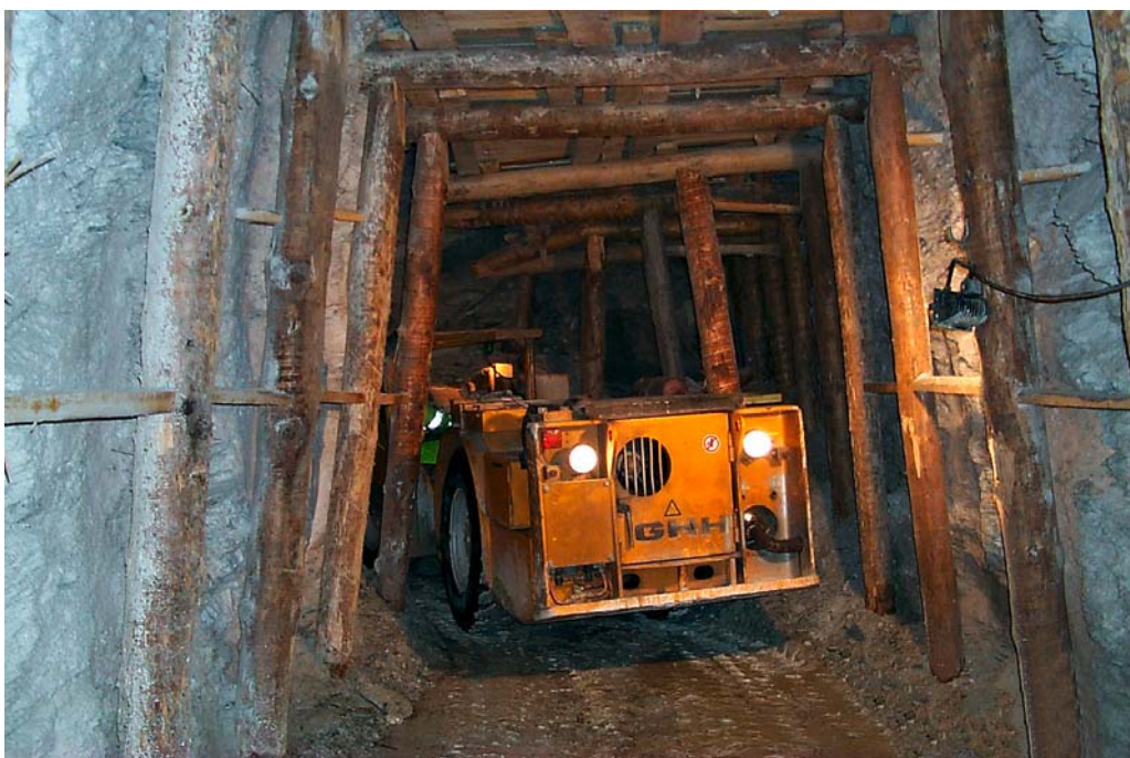
Abb. 78. Kleinpfeilerbruchbau im ehemaligen Leukophyllitbergbau Kleinfestritz (Foto: L. Weber; 2001).
