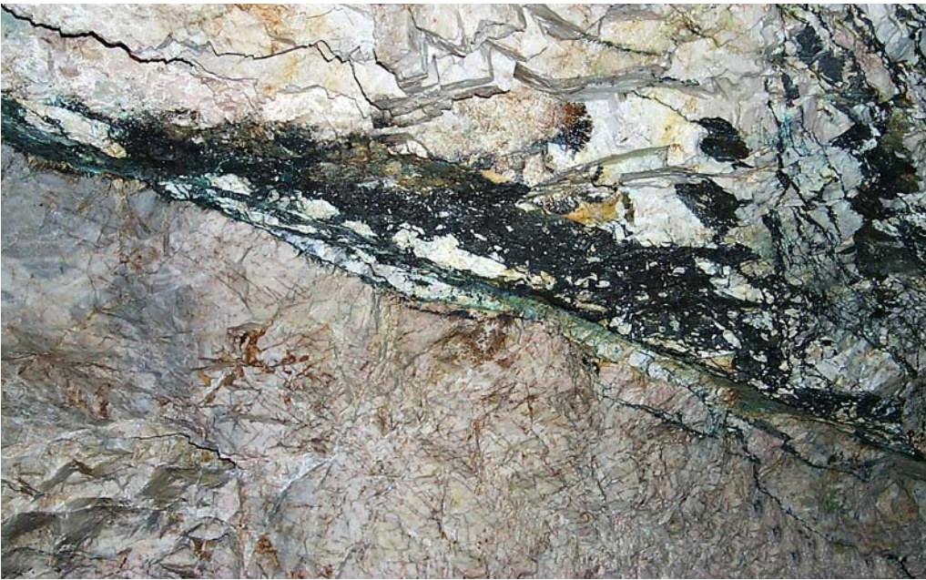
Abb. 56. Bergbau Falkenstein/Schwaz: Fahlerzkluff in der Firste der Ver- bindungsstrecke zum Schachtre- vier (Foto: L. Weber; 2000). Bild- breite 1m.
