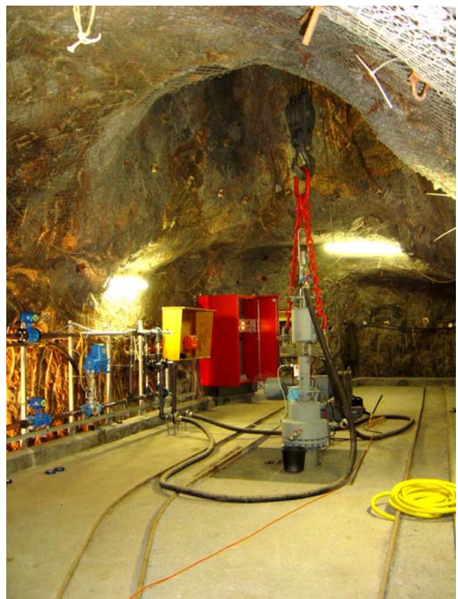
Abb. 70. Salzbergbau Hallstatt: Untertägige Bohrlochsonde (Foto: Salinen Austria AG). Fig. 70. Hallstatt Salt Mine: Underground Solution Mining (Photo: Salinen Austria AG).
