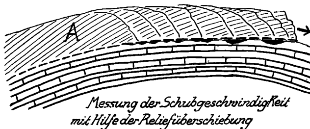
Bild 9. Unter der Schubmasse A liegt ein Relief, dessen Furchen in der Schubrichtung größer werden. Das könnte unter Umständen eine Messung der Schubgeschwindigkeit ermöglichen.
