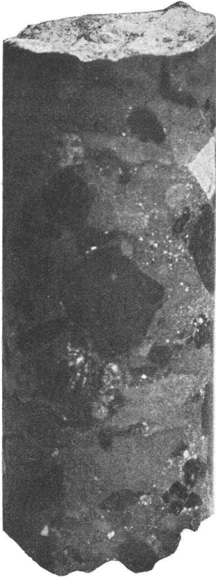
Figur 10. Bohrkern von Porphyrconglomerat aus 1080 m Tiefe. (Etwas verkleinert.)
