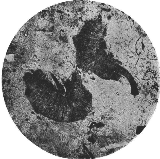
Figur 4 Steinthon (sog. Thonstein) aus dem Steinkohlenbergwerk Cons. Nordfeld. Dünnschliffbild ( 60\times ).
