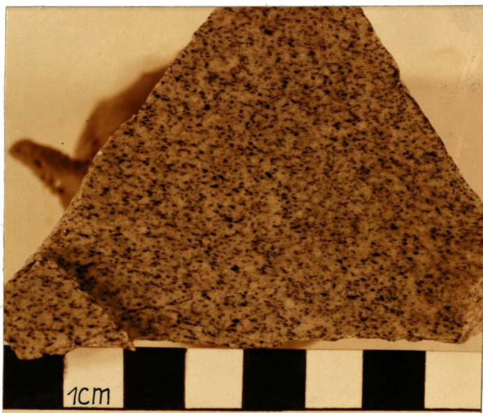
Abb. 4 Feinkörniger Metagranit aus demselben Bereich wie Abb. 3.
