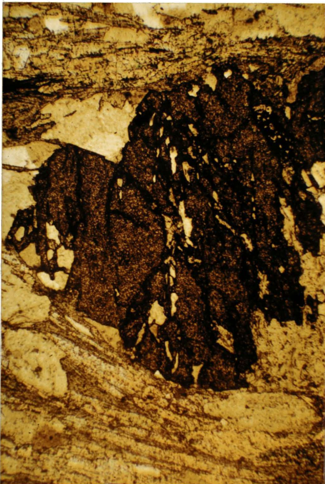
Abb. 36 : Granat mit s_i aus Quarz, welches relativ zu s_e um fast 90^\circ gedreht wurde. Der Granat wurde hier para- bis postkristallin gerollt. Probe aus dem Hellglimmerschiefer, E-Flanke des Grieswies Schwarzkogel SH 1950 m (ca. 60 x, ohne Pol)
