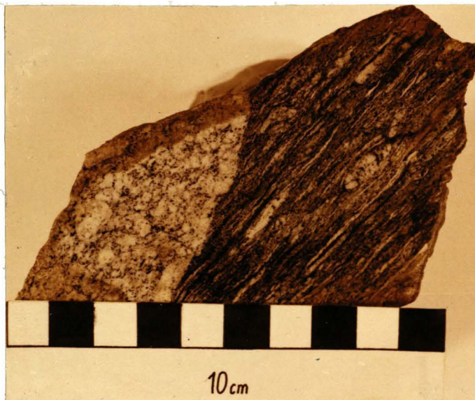
Abb. 5 Probe aus dem Grenzbereich zwischen Knappenhauswalze und überlagerndem Amphibolit am N-Rand des Pilatus Keeses in SH. 2300 m. Die Abb. zeigt den diskordanten Kontakt zwischen Granitgneis und Amphibolit. Der Granit ist in den bereits vorgelegenen Amphibolit eingedrungen.
