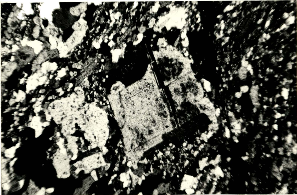
Abb. 18: Großplagioklas (Albit, 8 % An) in feinkörniger Matrix aus Hornblende, Quarz, Plagioklas, Biotit und etwas Karbonat. (Ca 35 x + Pol). Erfurter Weg, SH. 1800 m.
