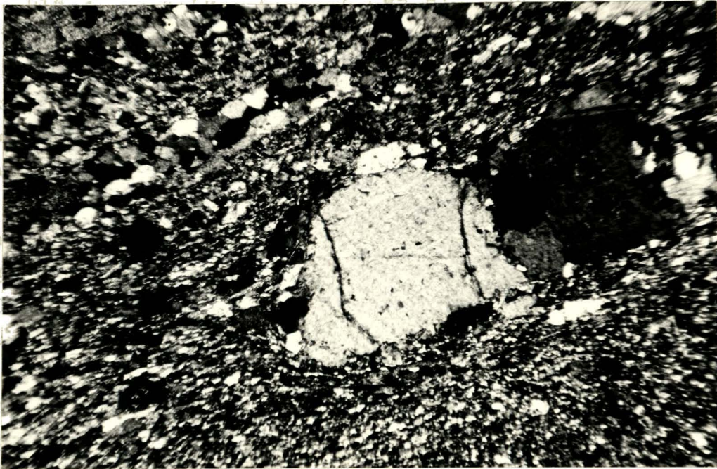
Abb. 33 a und b: Geröll (Lapillum) das in feiner Quarz-Albit-Hornblendematrix liegt und nur aus Plagioklas besteht. Man erkennt deutlich die tuffitische Natur dieses Gesteins (ca. 60 x verg. + Pol.) Lok.: Steinkarl S-Rand SH 1760 m
