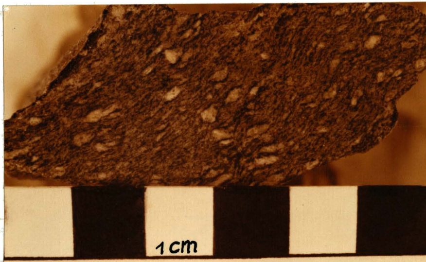
Abb. 50: Kalifeldspatgerölle-führender Phengit-Albit-schiefer. 150 m südlich P. 2781 am NNW-Grat des Grieswies Schwarzkogels.
