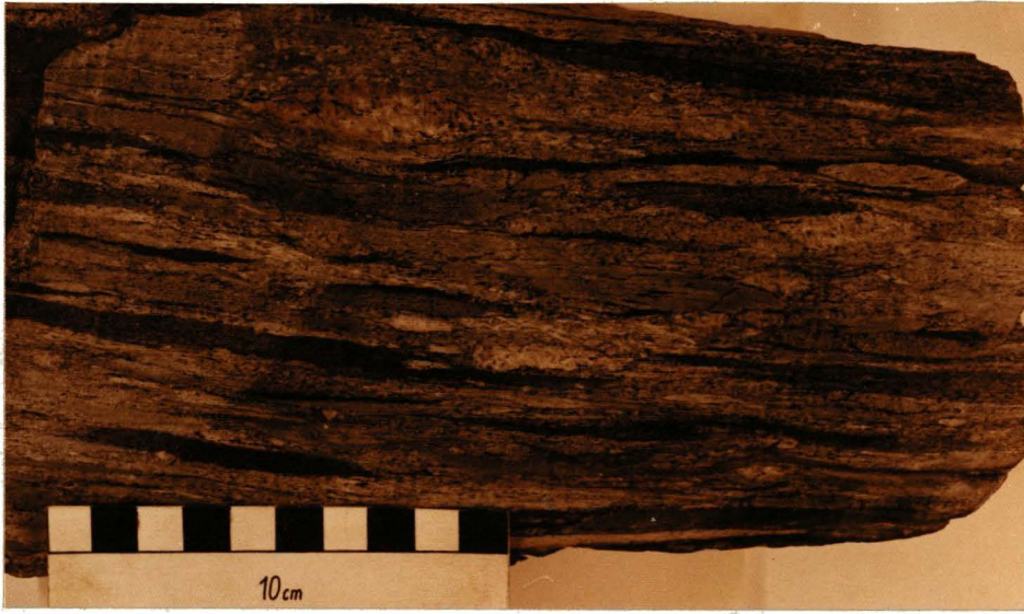
Abb. 31: Geröllgneis: Helle Plagioklasgneise, feinkörnige grüne Hornblendegneise und Biotitschieferkomponenten in einer feinen Grundmasse aus Hornblende, Plagioklas und Quarz. Lokalität: wie Abb. 30.
