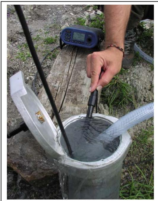
Abb.22: Einspeisung der salinaren Lösung / Kontrolle der elektr. Leitfähigkeit
