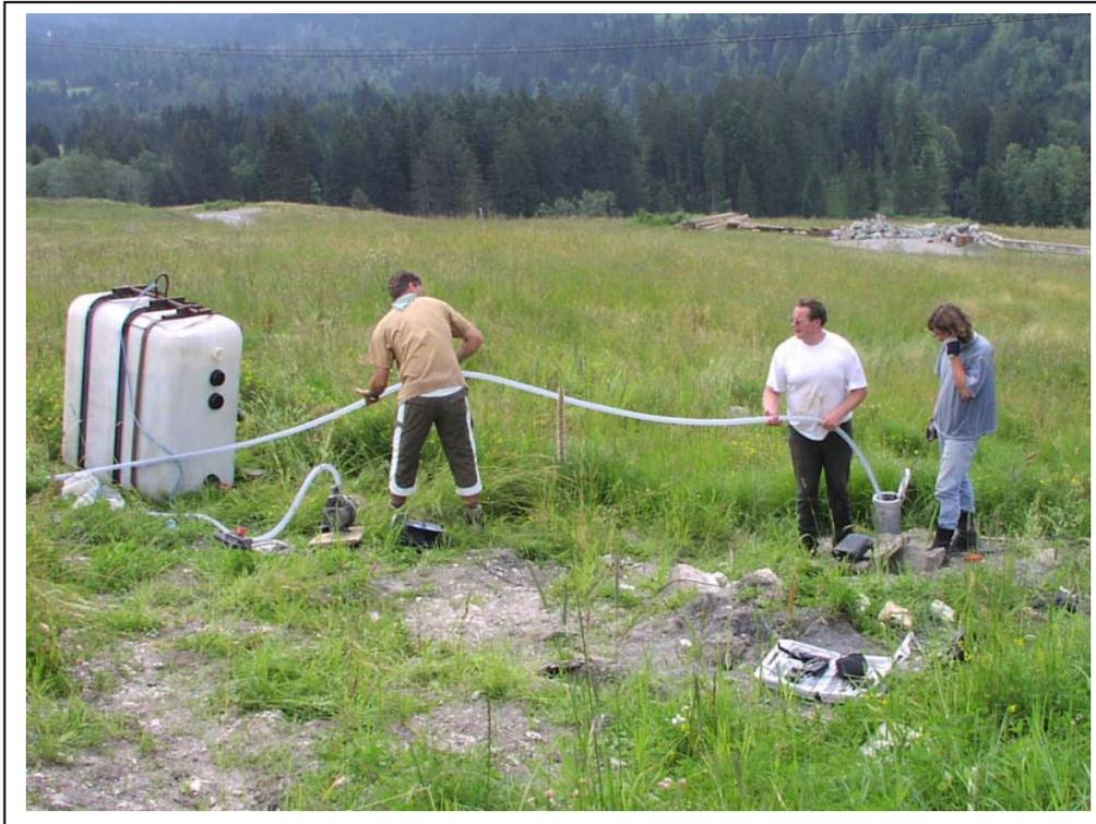
Abb.21: Vorbereitung zur Einspeisung der salinaren Lösung
