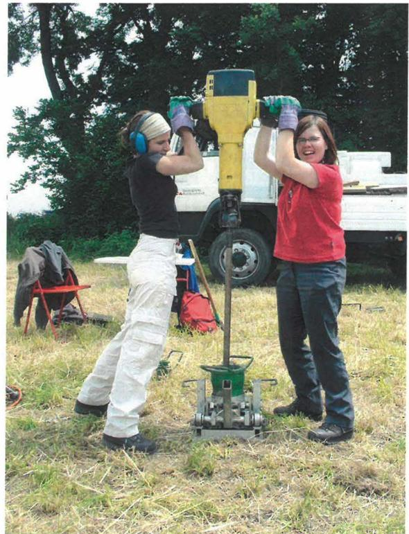
Abb. 4.26: Studenten bei einer Rammkernsondierungen bei der Bohrkampagne Sierning/Oberwolfertn 2004
