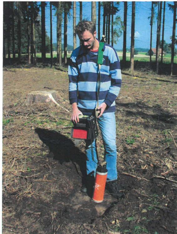
Abb. 3.49: Bodenradiometrische Messung mit Gammaspektrometer
