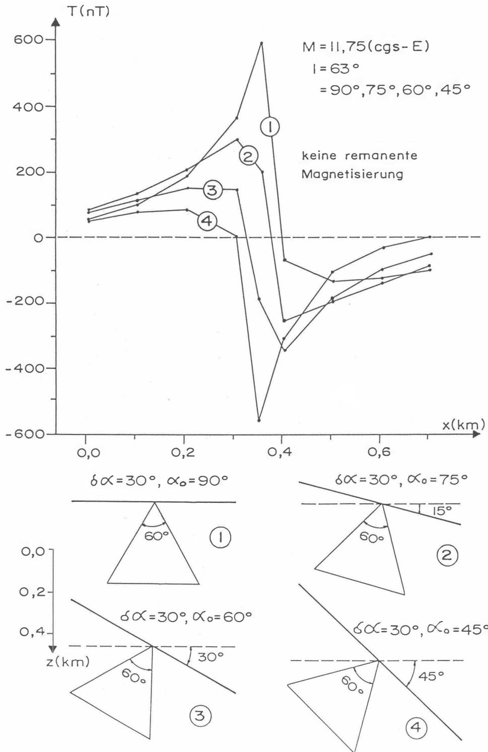
Abb. B4: Der Einfluß der mittleren Boden­neigung ( $\alpha_0$ ) auf die  $\Delta T$ -Anomalie;  $\delta\alpha$  = komplementäre Öffnungswinkel,  $Z$  = Tiefe in km.
