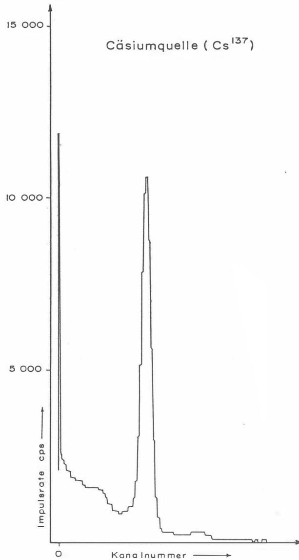
Abb. 3: GR-800 Gammastrahlenspektrometer (Kristall I) Spektralregistrierung (10. 6. 1983) — Cäsiumquelle (Cs<sup>137</sup>)
