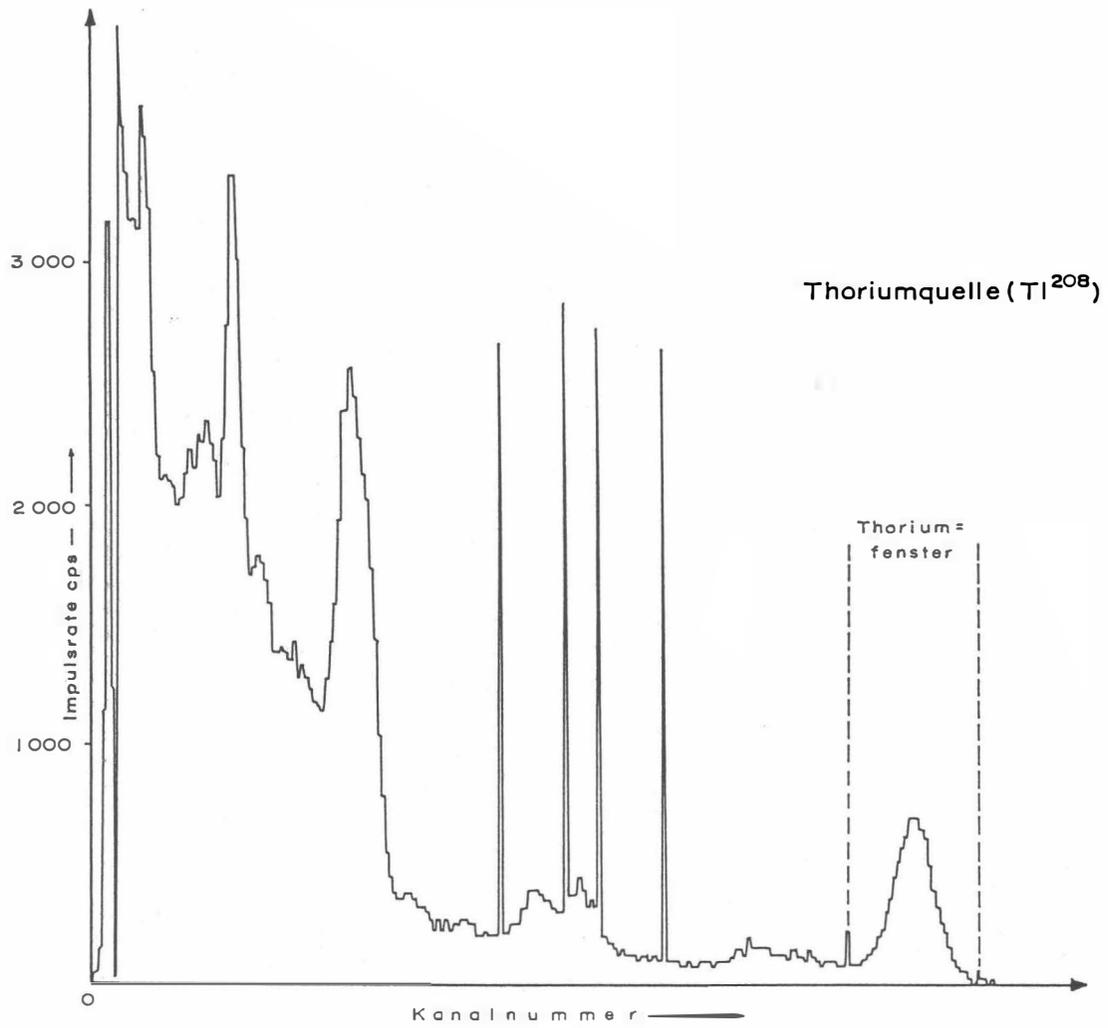
Abb. 4: GR-800 Gammastrahlenspektrometer (Kristall I) Spektralregistrierung (10. 6. 1983) — Thoriumquelle (Th<sup>208</sup>)
