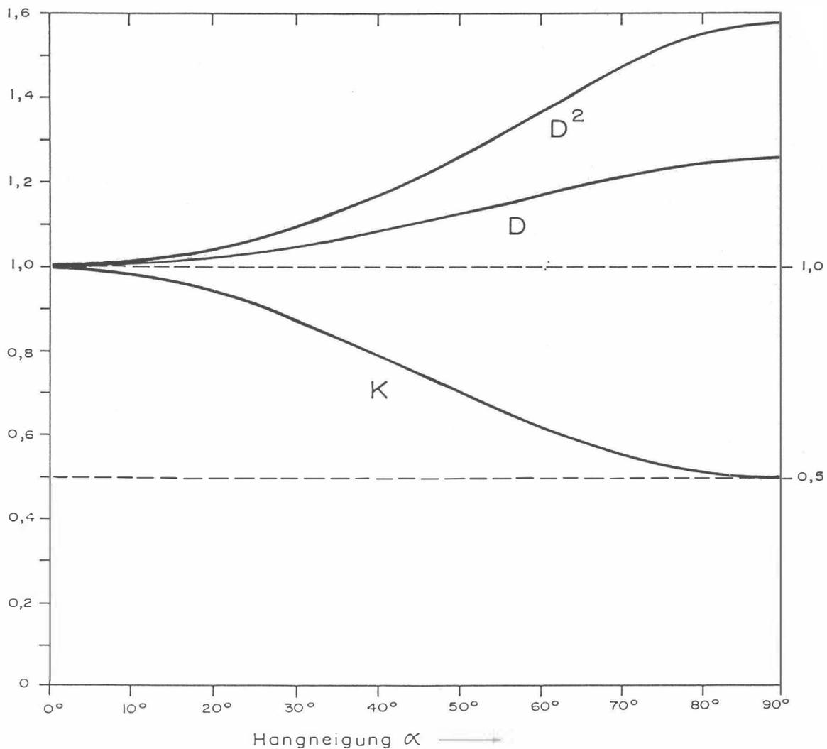
Abb. A2: Verfälschungsfaktoren  $K$ ,  $D$  und  $D^2$  in Abhängigkeit vom Neigungswinkel  $\alpha$  der Erdoberfläche für ein koplanares EM-System mit vertikalem Sendedipol;  $q$  = Quotient Horizontal- zu Vertikal-komponente des sekundären Magnetfeldes.
