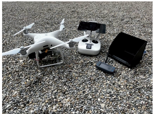
Abb. 10. DJI Phantom 4Pro mit RGB-Aufnahmeeinheit und zusätzlicher Thermalkamera Flir VuePro 640 UAV.
