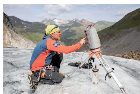
Abb. 8. Terrestrischer Laser-scanner VZ 4000 im Geländeeinsatz.
