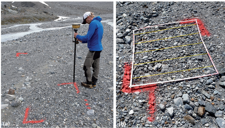
Abb. 14. Anordnung der Beprobungsflächen in der Schotterebene des Gletschervorfelds, markiert mit umweltfreundlichen, wasserbasierten Farben. a) Die Eckpunkte der Analyseraster wurden mit dGPS georeferenziert; b) zeigt einen Beprobungsrahmen mit parallel-gespannten Schnüren (gelb markiert) und noch ungestörten Oberflächensedimenten vor der Einzelkornvermessung.
