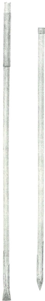
Fig. 4 und 5. Meißelbohrer aus eisenbeschlagenen Holzstäben. ( \frac{1}{10} der natür- lichen Größe.)
