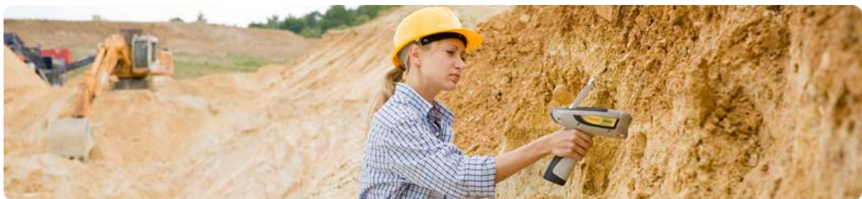
Abb. 5.1.: Einsatz des tragbaren Röntgenfluoreszenz-Analysator (© Analyticon, 2008)
