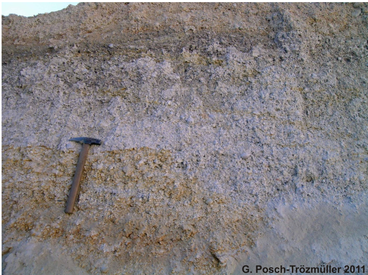
Abb. 2.2.37.: Detailansicht der Kiese: Es ist eine Sortierung erkennbar, außerdem tritt die rostrote Verfärbung auch in tieferen Partien auf.
