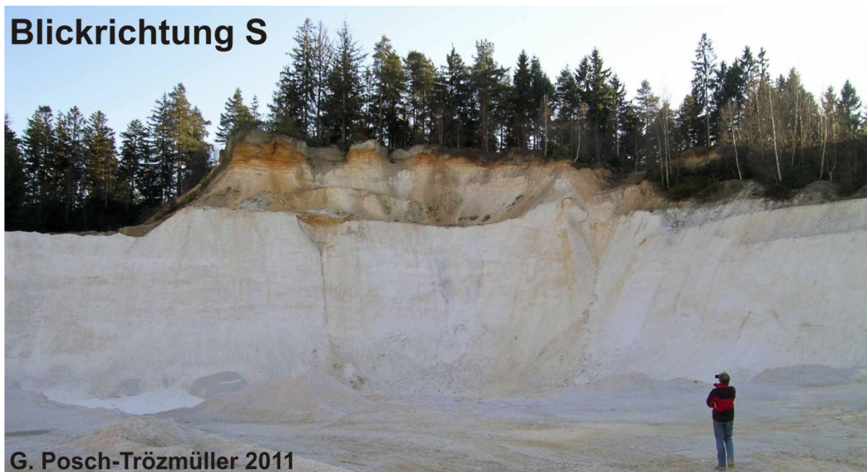
Abb. 2.2.31.: Blick auf die S-Wand der Kiesgrube: Im Hangenden rostrot verfarbte Konglomerate, darunter weißgraue Kiese.
