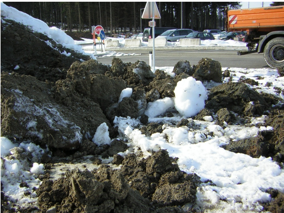
Abb. 2.3.6.: Baustelle Kleinzell im Mühlkreis: dunkelgraue bis braune sandige Schluffe und Tone (März 2010, Elfriede Ruprecht-Porod).
