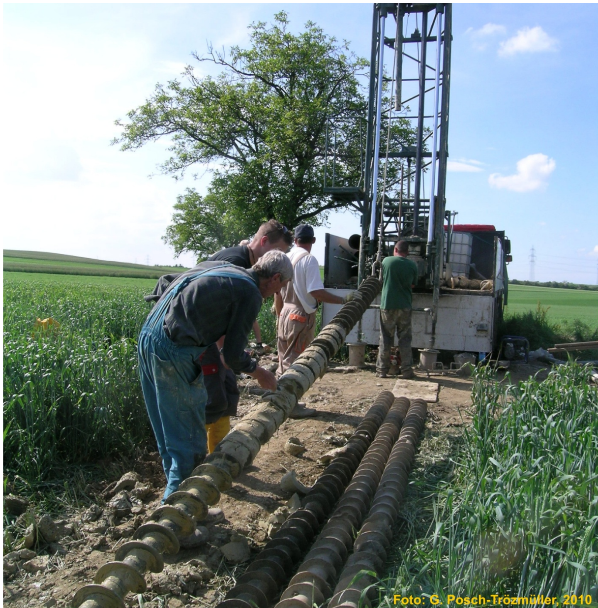
Abb. 2.6.: Probenahme bei der Spiralbohrmethode.
