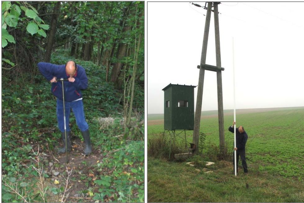
Abb. 6.-3: Handbohrung eines Sondierloches und Einbau eines Pegels.
