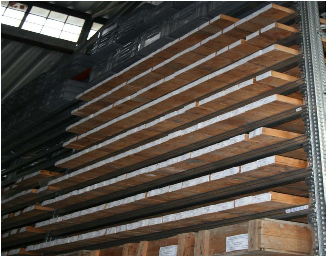
Abb. 9: Einheitliche Etikettierung der Bohrkernkisten
