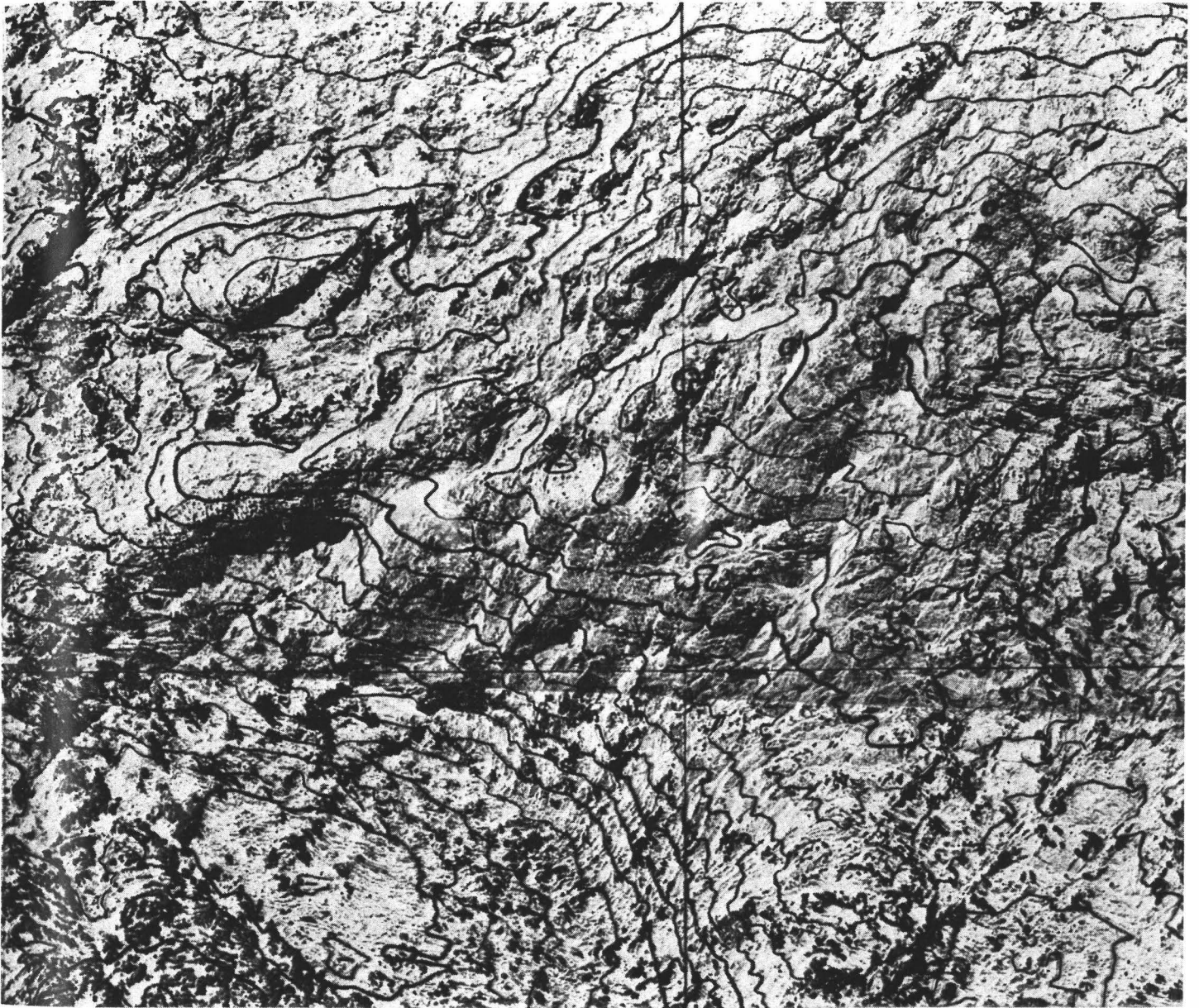
Abb. 2: Orthophoto mit 20-m- Schichtlinien
