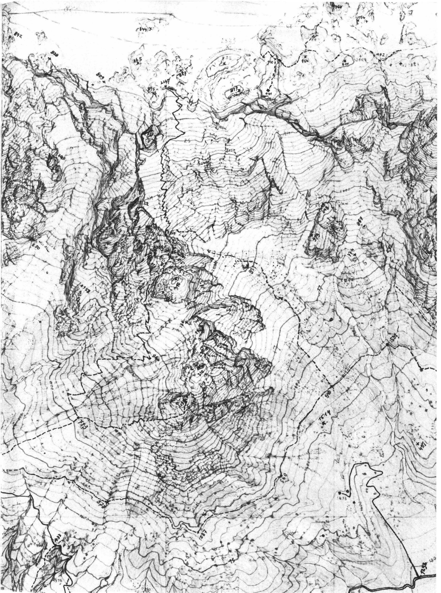
Farben der Vorlage (Transparentfolie): dunkelblau - Luftbildkartierung (Rückseitendruck); schwarz - Wegnetz, Koten, Felskanten- und -Gefügezeichnung; rot - km-Gitter, Formverbesserungen an Höhenlinien aus dem Raumbildvergleich, Kantenzzeichnung im begrüntem Bergland; hell- und mittelblau - Firn und Kantenzzeichnung im Firn; gelb - Almgrasflächen; orange - Latschen; grün - Wald.
